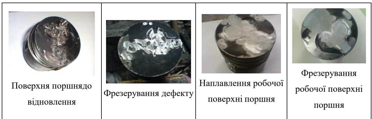
Рисунок 3.9 - Етапи відновлення робочої поверхні поршня
