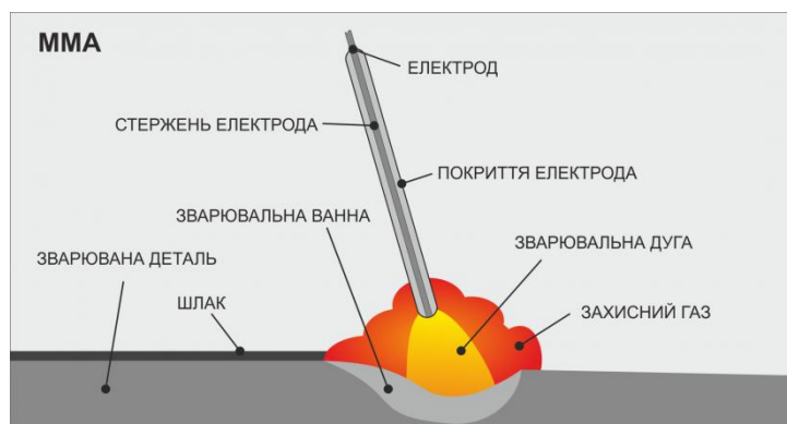
Рисунок 1.1 - Схема зварювання з застосуванням покритих електродів:
