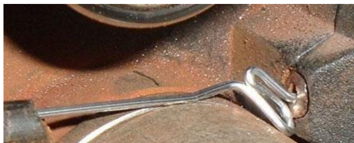
Рисунок 1.3 - Згинання алюмінієвого дроту в механізмі подачі
