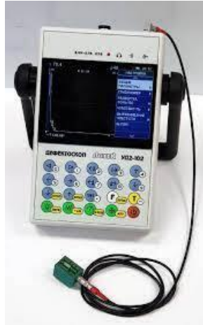
Рисунок 3.8 - Ультразвуковий дефектоскоп УД2-102
