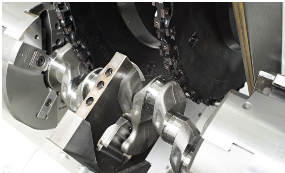
Рисунок 3.1. Установка колінчастого валу на верстаті для обробки шатунних шийок
