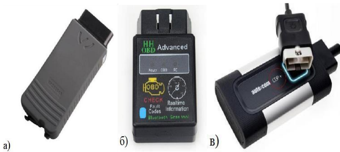
Рисунок 1.1 – Зовнішній вигляд сканерів : а - дилерський сканер концерну VAG; б - портативний сканер, в - мультимарочний сканер
