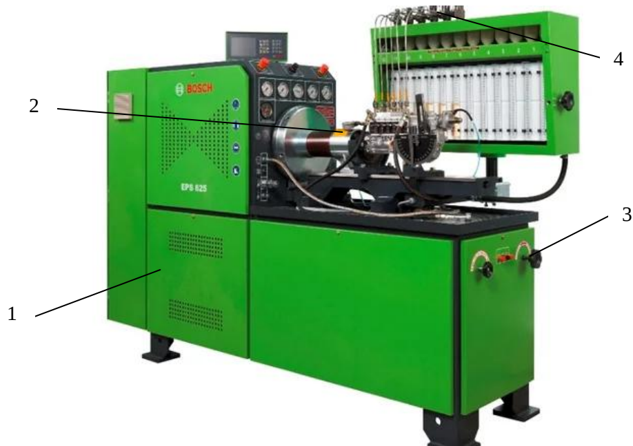
Рисунок 2.4 – Стенд для перевірки плунжерних паливних насосів дизельних двигунів
