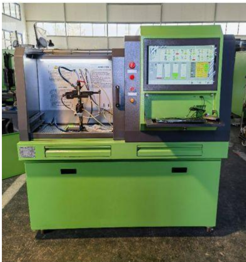
Рисунок 3.16 - Загальний вигляд станда MAK TEST для перевірки і ремонту форсунок
