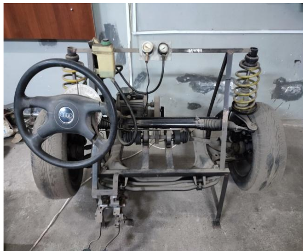
Рисунок 3.3 - Стенд для випробування підвіски і гальм
