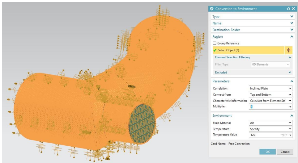
Рис. 3.32. Налаштування параметрів теплообміну з навколишнім середовищем.
