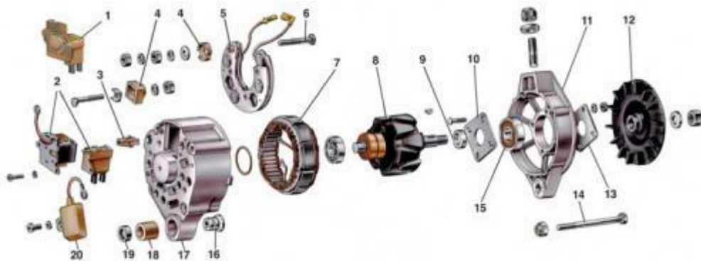
Рис. 3.6. Ремонт і демонтаж генератора:
