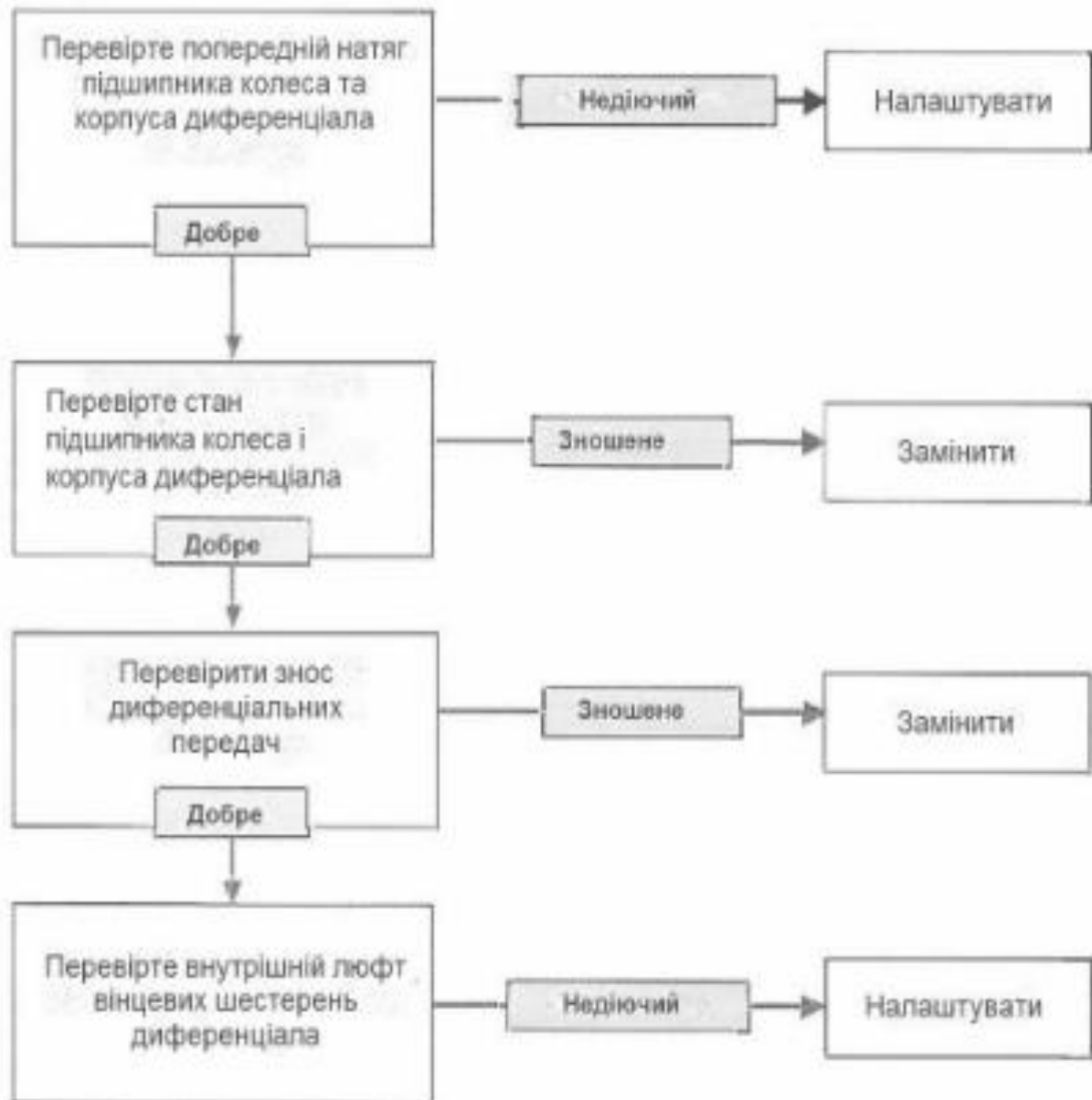
Рисунок -2.2 Послідовність дій при пошуку причини шумної роботи головної передачі і диференціала при проходженні поворотів.
