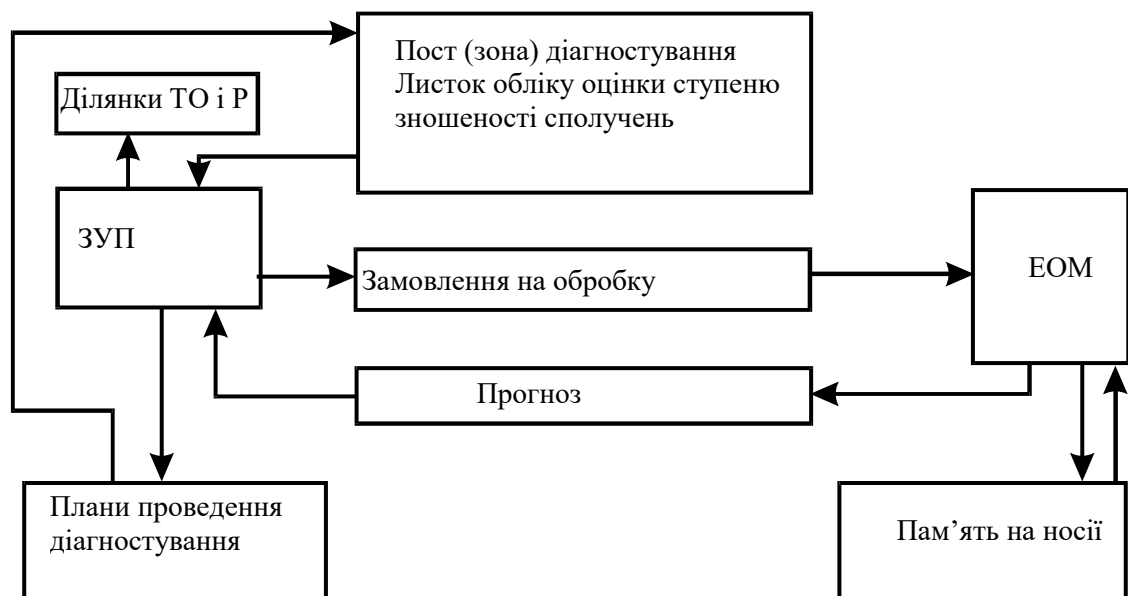
Рисунок - 4.1. Схема процесу прогнозування залишкового ресурсу силових агрегатів.
