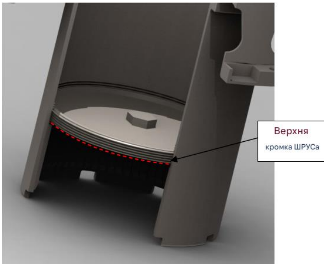
Рис. 4.54. Чашка, встановлена в маточину колеса (квартальний розріз маточини).
