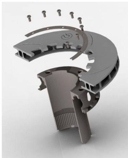
Рис. 4.51. Схематичний вибуховий вигляд маточини колеса та гальмівного диска.
