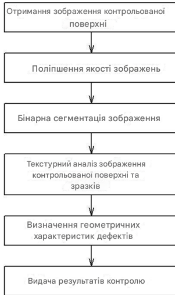
Рис. 4.21. Алгоритм цифрової обробки зображень для виявлення дефектів лакофарбового покриття.
