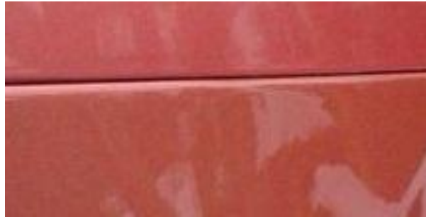
Рис. 1.7. Дефект неоднорідне забарвлення.
