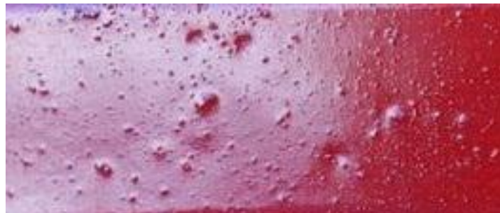
Рис. 1.4. Дефект під назвою кратери.
