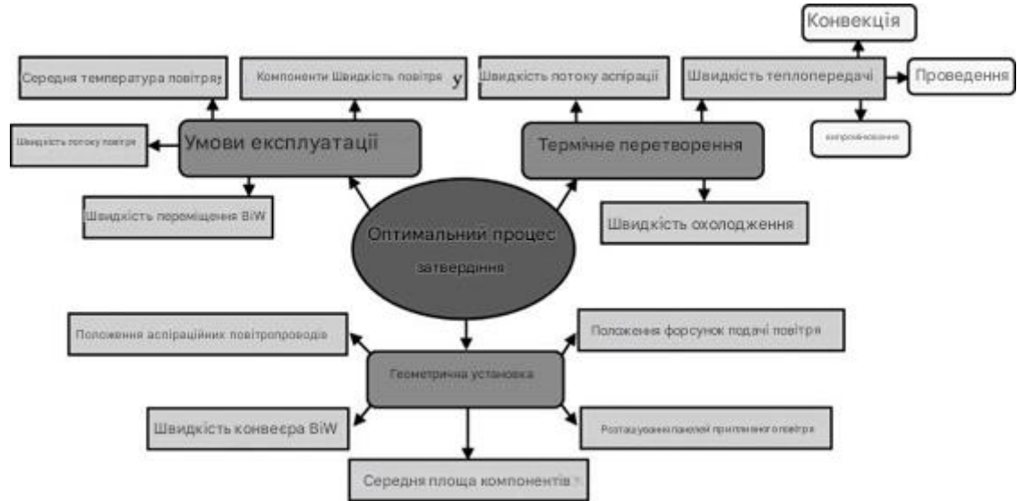
Рис. 2.17. Карта ключових факторів, що впливають на процес затвердіння та сушіння.
