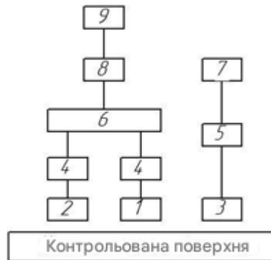
Рис. 1.17. Схема діагностичного комплексу для автоматизованого контролю лакофарбового покриття.
