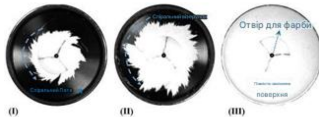
Рис. 2.9. Розповсюдження фарбувальної плівки по внутрішній поверхні чаші дзвона, представлено у вигляді серії експериментальних знімків (обертальна швидкість чаші x=30k , подача фарби m=400\text{мл/хв} ).
