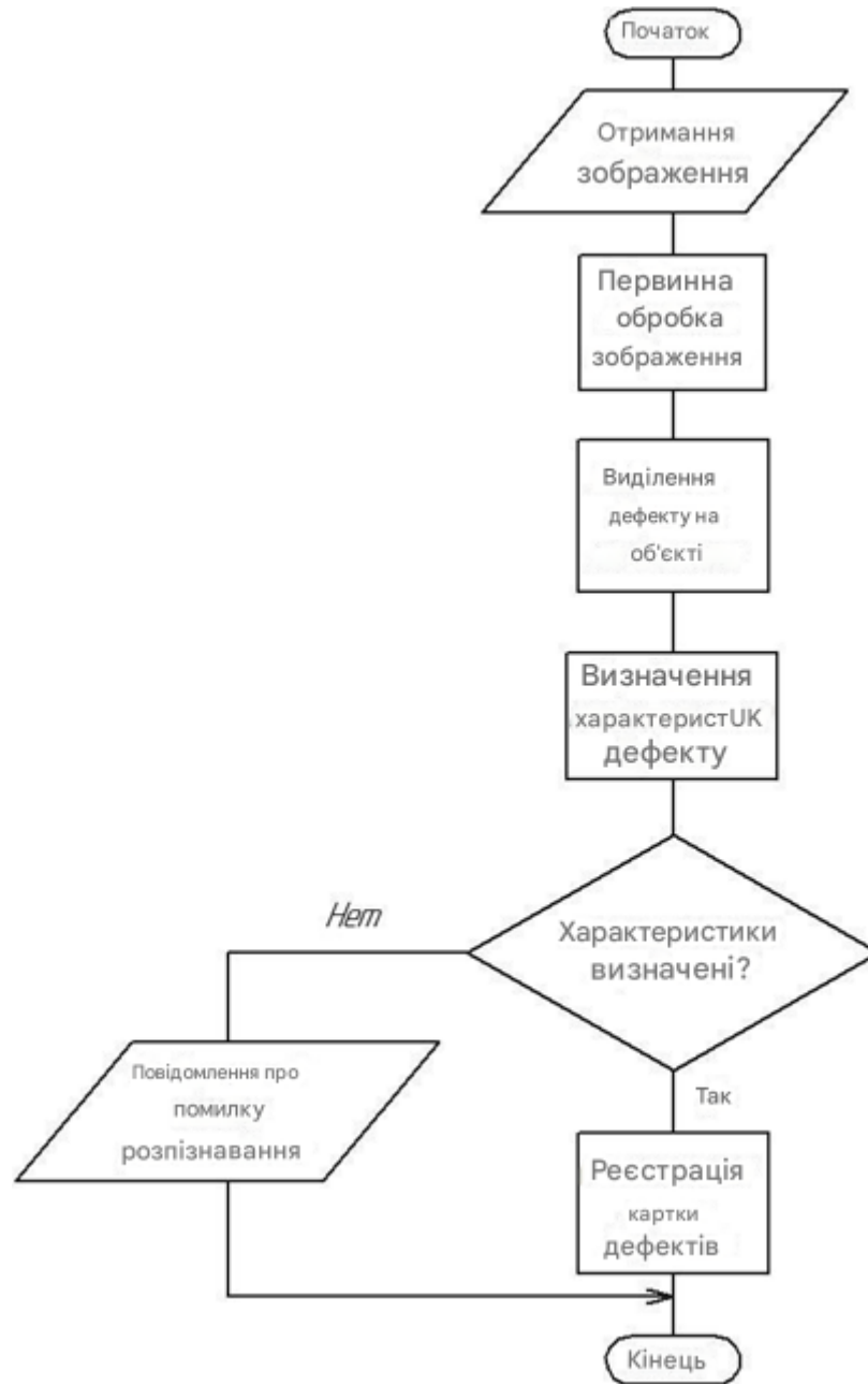
Рис. 4.19. Алгоритм виявлення дефектів.
