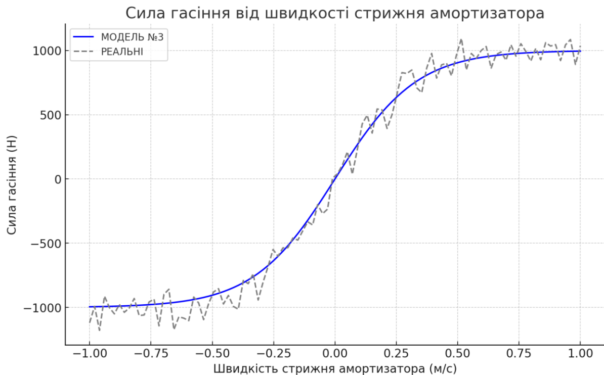
Рис. 4.4. Порівняння гістерезисних характеристик амортизатора: фактичні дані та третя модель.
