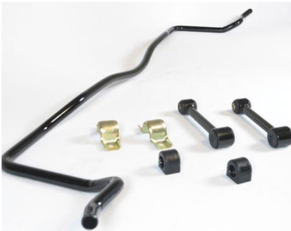
Рис. 1.3. Компоненти стабілізатора поперечної стійкості.
