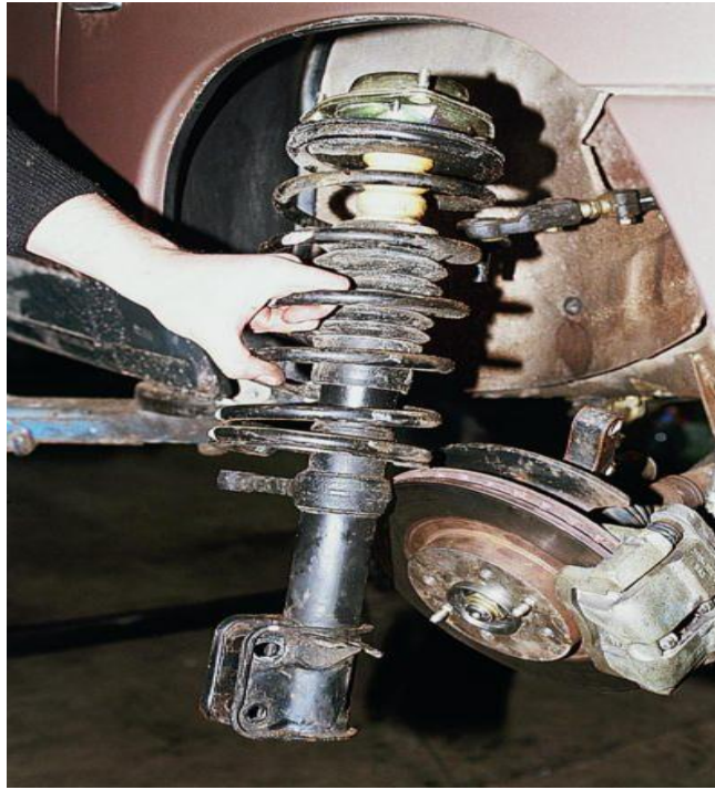
Рис. 2.3. Амортизаційна стійка в зборі.
