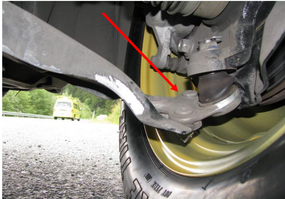
Рис. 2.7. Шарова опора, яка ілюструє кріплення та основні частини компоненту.
