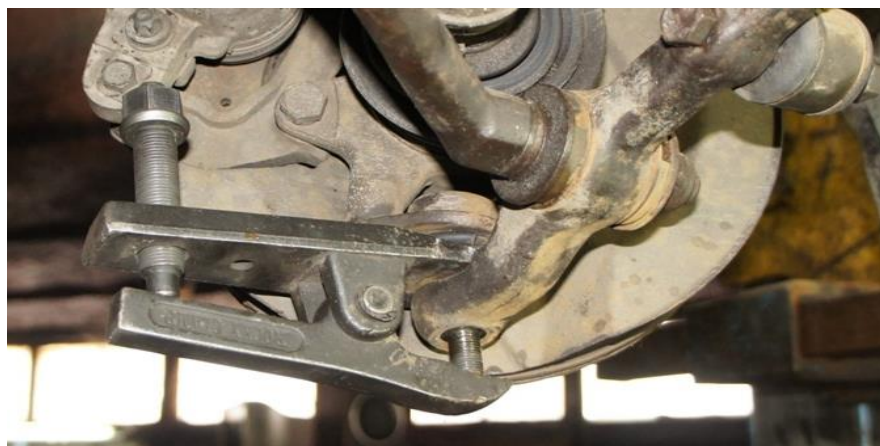
Рисунок 2.8. Випресування кульової опори універсальним знімачем
