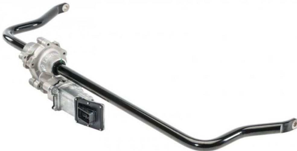
Рис. 1.5. Активний стабілізатор поперечної стійкості.
