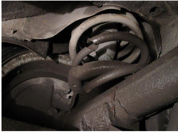
Рис. 2.2. Приклад поломки пружини, що вимагає негайного втручання для забезпечення безпеки та комфорту під час руху.
