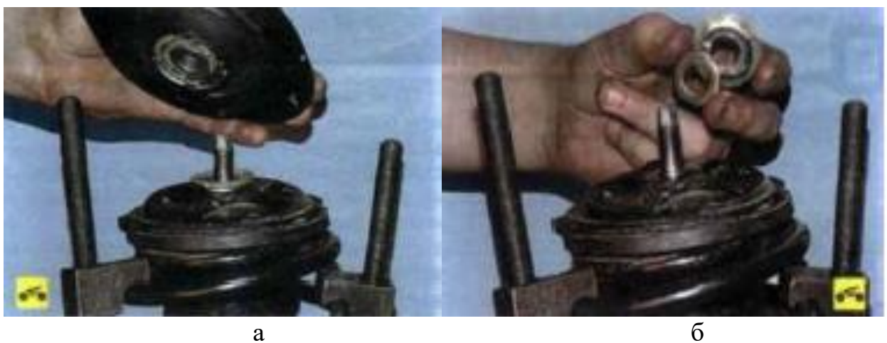
Рис. 2.4. Схема знімання верхньої опори та шайб.
