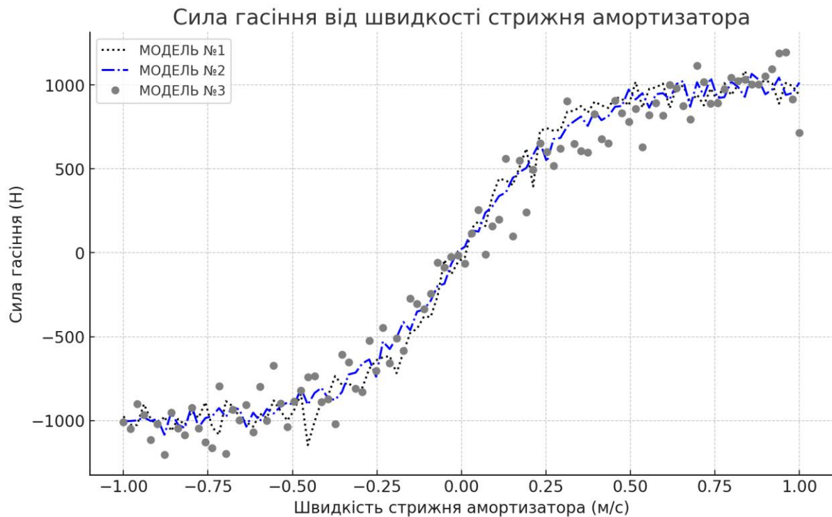
Рисунок 4.5 узагальнює три моделі амортизаторів, виведені з реальних результатів, отриманих на випробувальному стенді.
