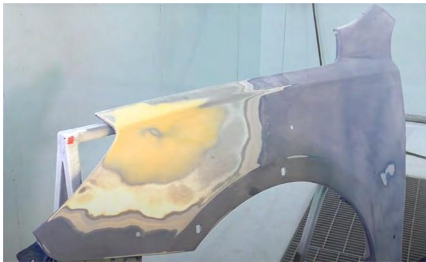
Рис. 2.17. Крило після шпаклівки та шліфування.
