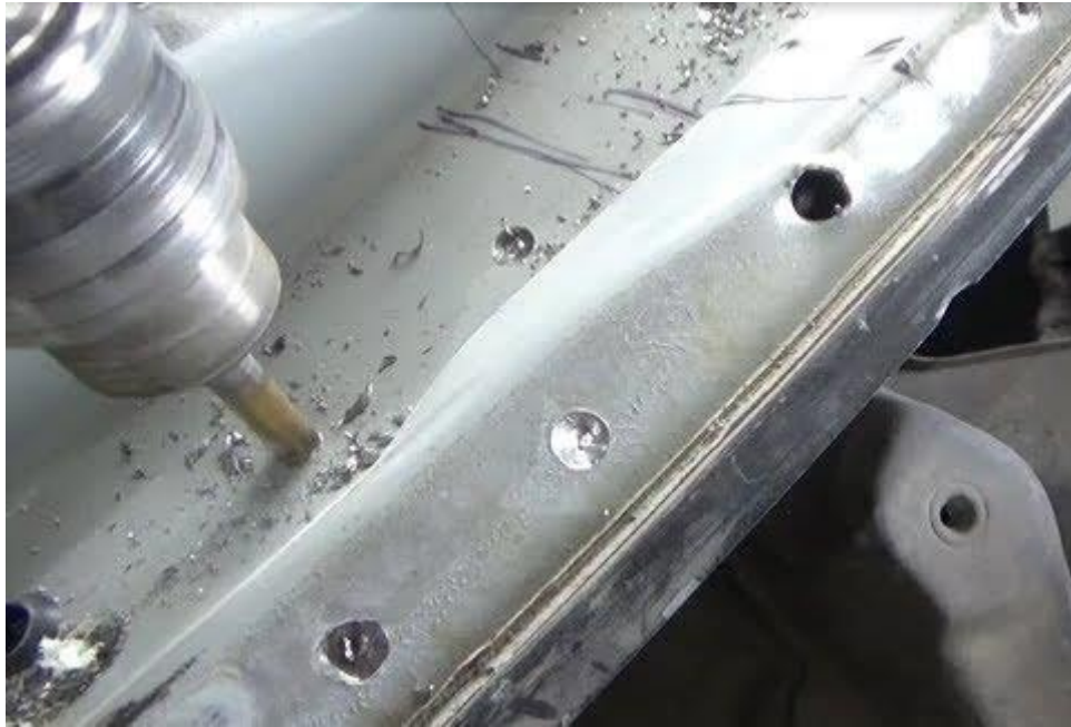
Рис. 2.3. Висвердлювання зварних точок.
