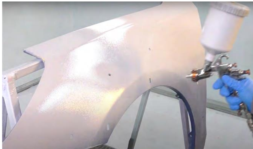
Рис. 2.18. Процес нанесення першого шару ґрунту-наповнювача.
