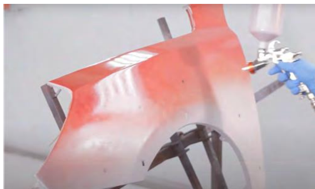
Рис. 2.22. Процес нанесення базової емалі перший шар.
