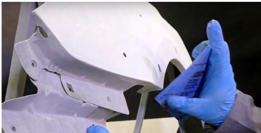
Рис. 2.19. Шліфування важкодоступних місць за допомогою губки софт тач.
