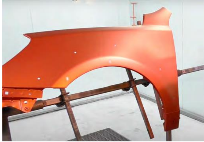
Рис. 2.23. Деталь після нанесення базового покриття.
