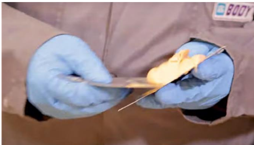
Рис. 2.11. Техніка змішування шпаклівки.
