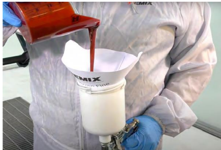
Рис. 2.21. Процес наповнення фарбопульту базовою емаллю.
