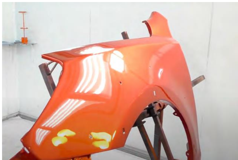
Рис. 2.24. Деталь після нанесення лаку та сушіння.
