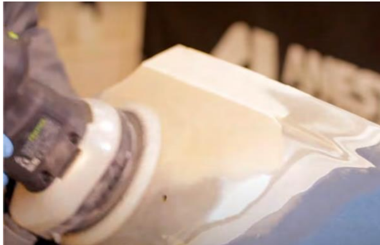
Рис. 2.14. Попереднє вирівнювання поверхні.
