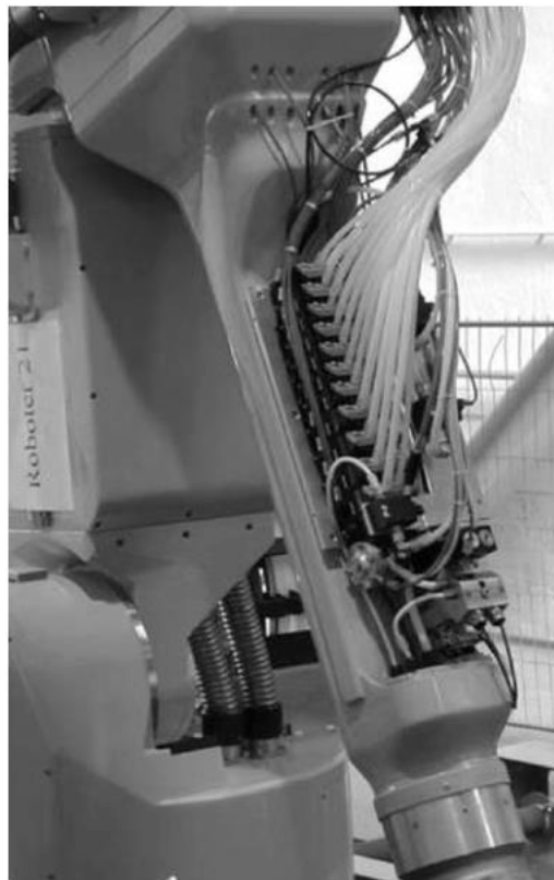
Рис. 4.6. Вбудована установка для зміни кольорів у маніпуляторі робота.
