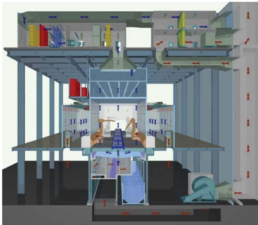
Рис. 4.1. Схематичний розріз фарбувальної камери.
