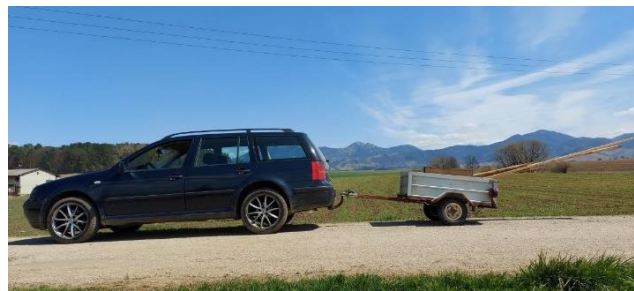
Рис. 4.13. Автентична комбінація автомобіль-причіп із центром ваги вантажу, що розташований за межами причепа.
