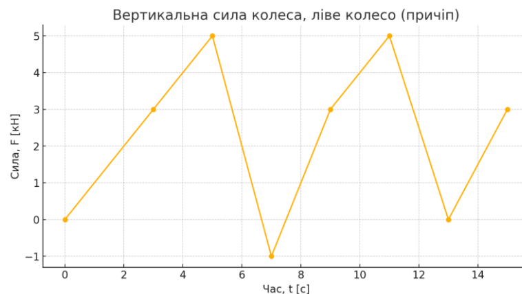
Рис. 4.8. Діаграма сумарної вертикальної сили на колесо причепа.
