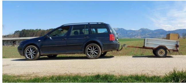
Рис. 4.10. Автентична комбінація автомобіль-трейлер з вантажем у задній частині.
