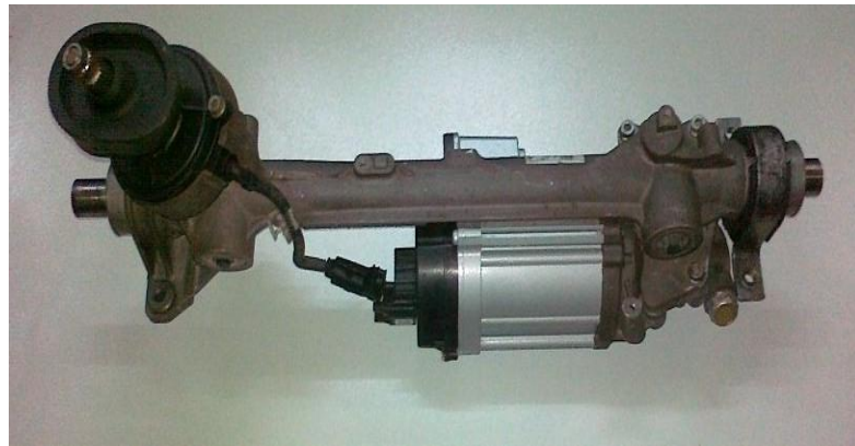
Рисунок 1.19 – Електрична Рульова рейка VOLKSWAGEN Golf V
