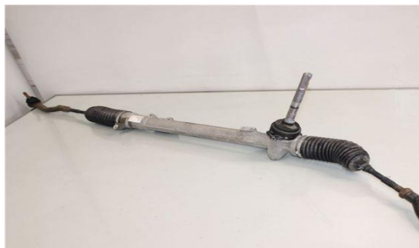
Рисунок 1.14 – Механічна рульова рейка автомобіля Nissan X-Trail
