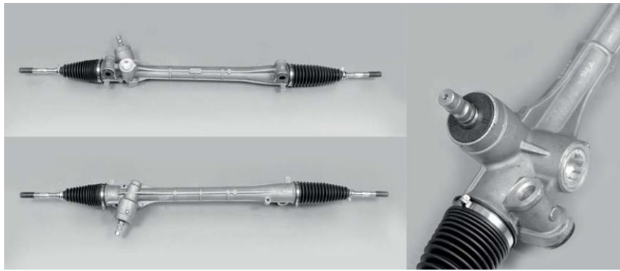
Рисунок 1.11 – Механічна рульова рейка автомобіля Infiniti FX-50
