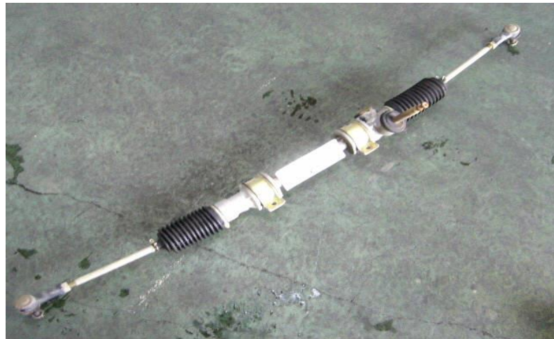
Рисунок 1.12 – Механічна рульова рейка автомобіля Daihatsu Materia
