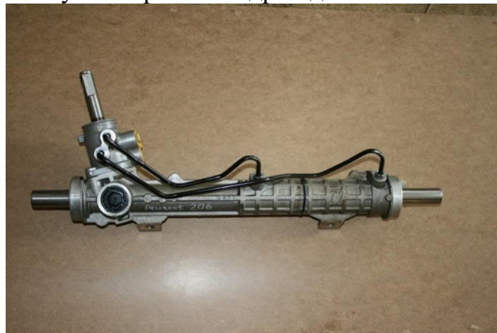
Рисунок 1.16 – Рульова рейка з гідропідсилювачем Porsche Cayenne
