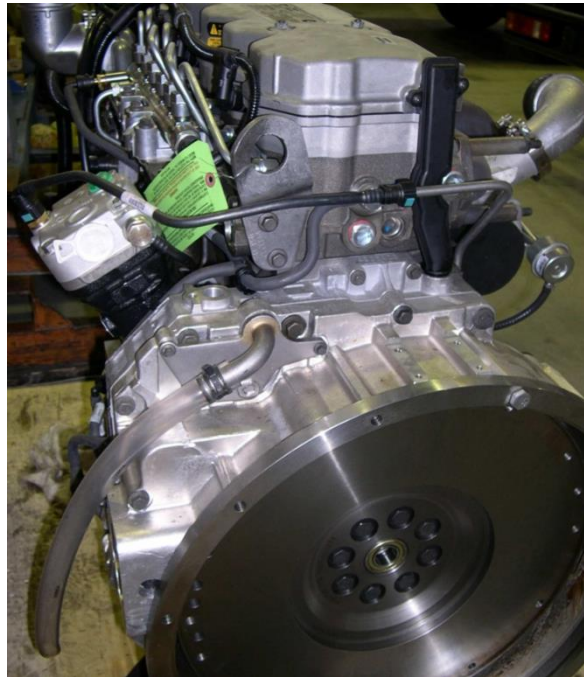
Рисунок 1.13 – Відкрита СВК двигуна КАМІНЗ
