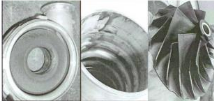
Рисунок 1.2 – Закоксовування деталей ТКР від неефективної роботи закритої СВК ДВЗ
