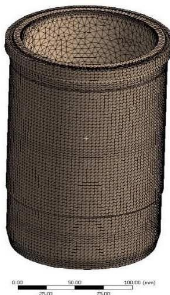
Рисунок 2.22 – Кінцево-елементна модель гільзи циліндрів (варіант 1)
