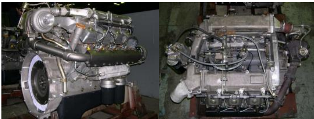
Рисунок 1.5- Загальний вигляд V-подібних двигунів V8 (зліва) і V6 (справа)
