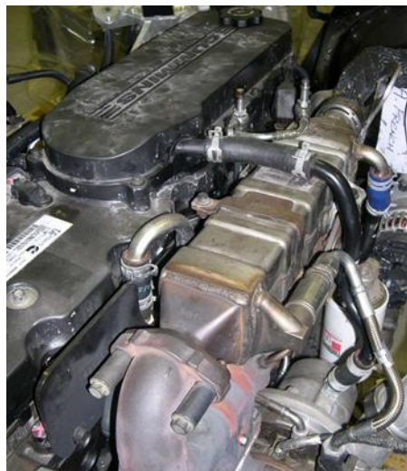
Рисунок 1.14 – Закрита СВК двигуна КАМІНЗ
