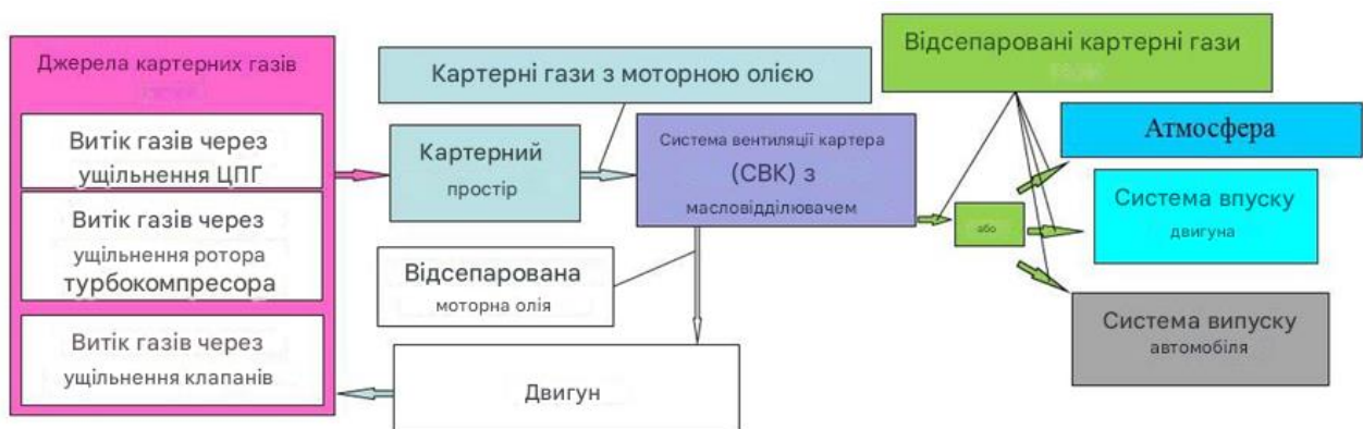
Рисунок 1.3 – Схема виникнення та руху КГ
