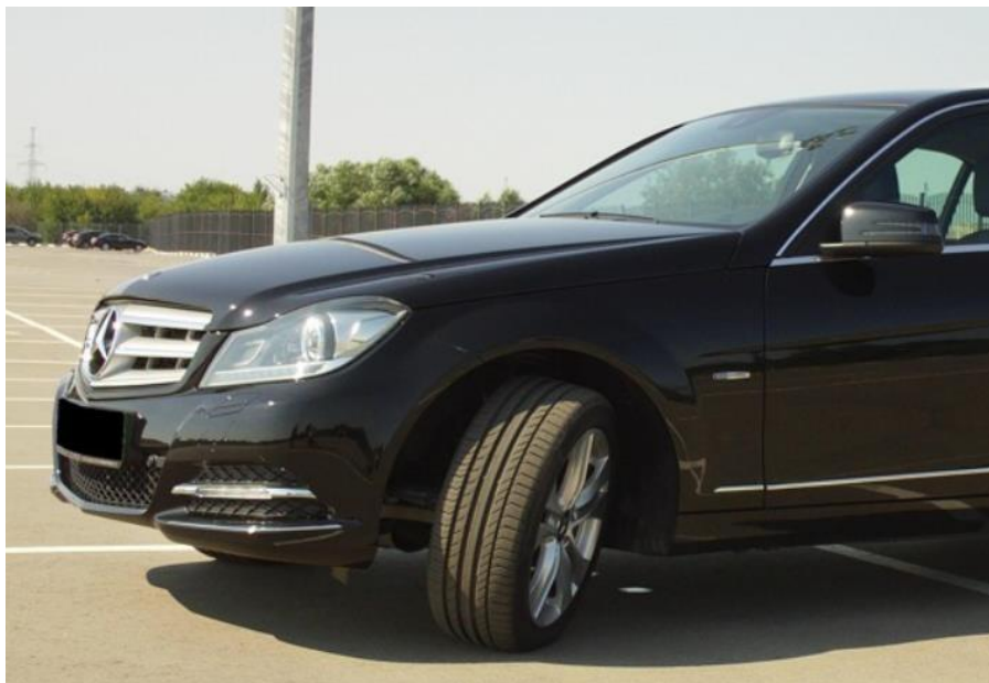
Рисунок 3.2 - Позитивний розвал внутрішнього колеса автомобіля Мерседес-Бенц при повороті, викликаний кутом нахилу осі повороту
