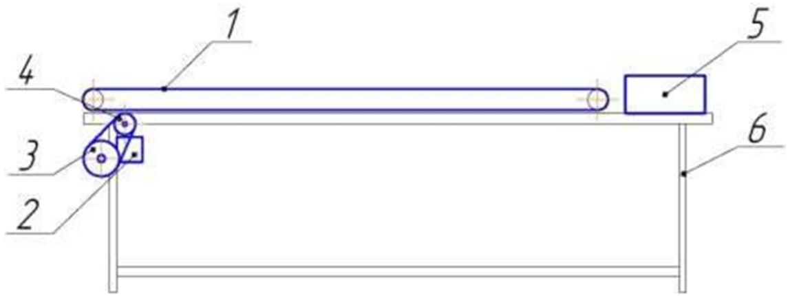
Рис. 4.4. Схема стенду для дослідження стійкості транспортного засобу: 1 - транспортувальна стрічка; 2 - електричний двигун; 3 - ведучий шків; 4 - ведений шків; 5 – перемикач швидкостей; 6 – стіл
