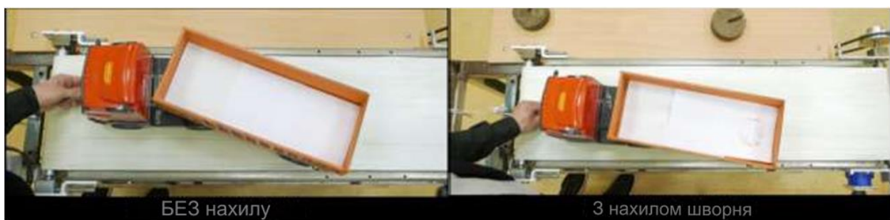
Рис. 4.7. Рух незавантаженого автопоїзда по стрічкової доріжці: а) без нахилу шворня; б) з нахилом шворня
