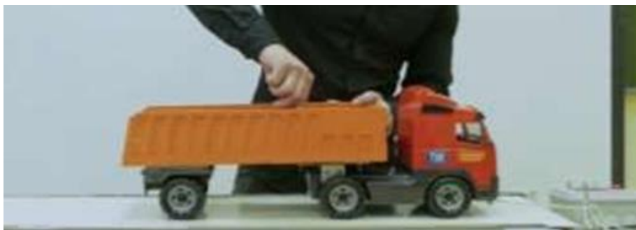
Рис.4.5. Масштабна модель автомобільного поїзда з похило-поворотною платформою
