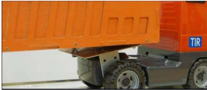
Рис. 4.6. Похило поворотна платформа з регулювальним гвинтом для установки кута нахилу шворня
