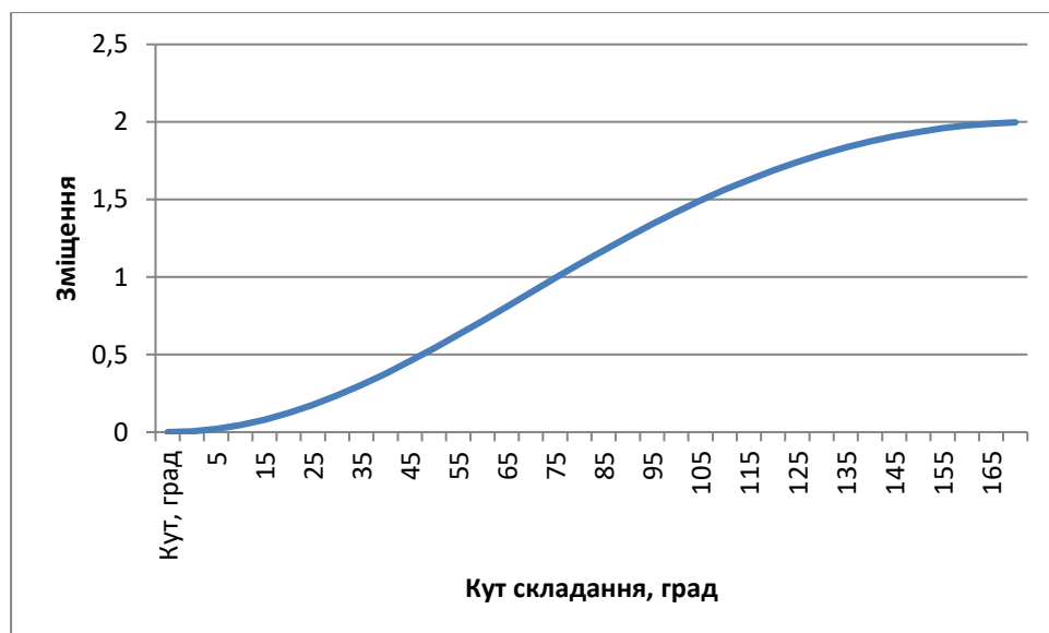
Рис. 2.5. Залежність зміщення Е від кута складання
