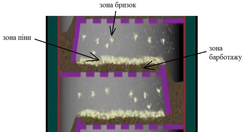
Рисунок 3.7. Модель процесу взаємодії пари та флегми на тарілках ректифікаційної колони
