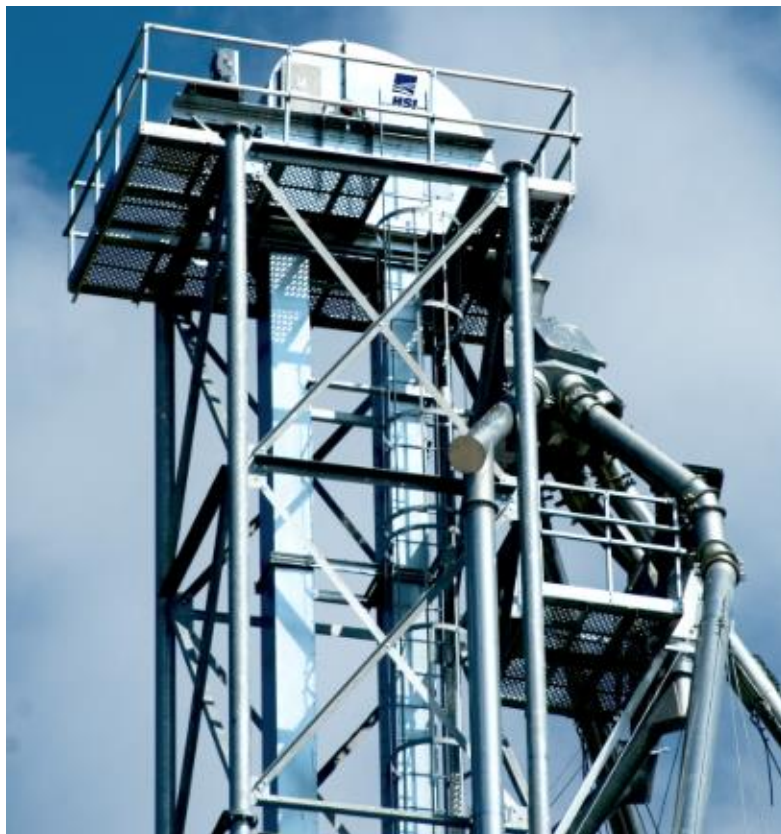
Рисунок 2.4 - Система розподілення потоків зерна норійної вежі
