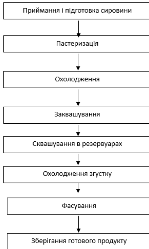
Рисунок 3.1 – Технологічна схема виробництва ферментованих напоїв з маслянки резервуарним способом
