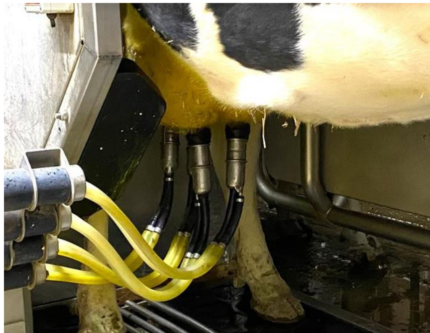
Рисунок 2.2 - Чашки, прикріплені доїльним роботом до вимені корови.
