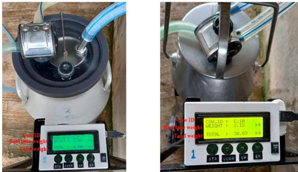
Рисунок 4.2 - Вага в реальному часі на ЖК-дисплеї, що відображає блок керування №2 і блок керування №1.
