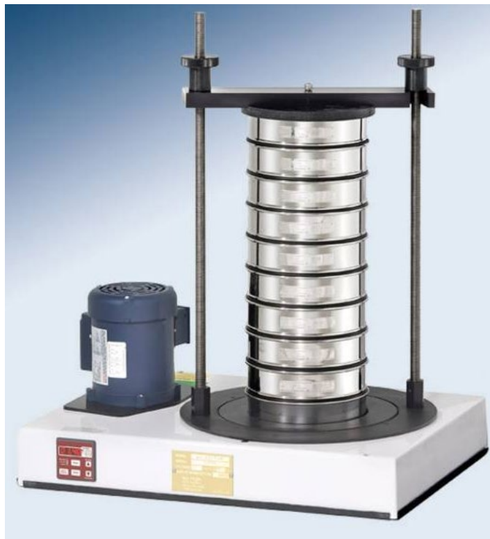
Рисунок 2.3. Лабораторний просіювач для визначення гранулометричного складу
