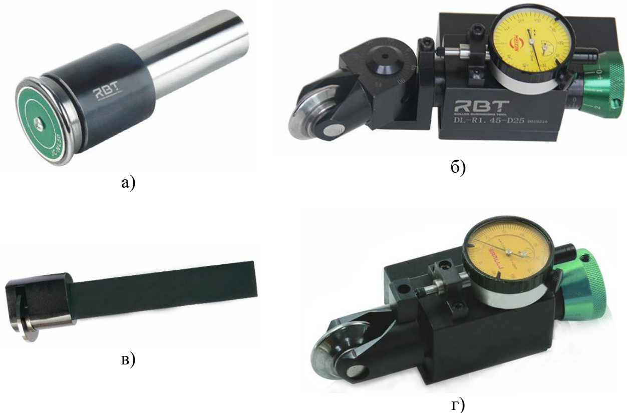
Рисунок 1.7 – Конструкції інструментів із роликами для розкочування внутрішніх та зовнішніх канавок від Компанії RBT (Roller Burnishig Tool): а), в) для обробки внутрішніх канавок; б) з можливістю регулювання кута розташування ролика г) для оброблення зовнішніх циліндричних поверхонь, канавок та складних профілів [25]
