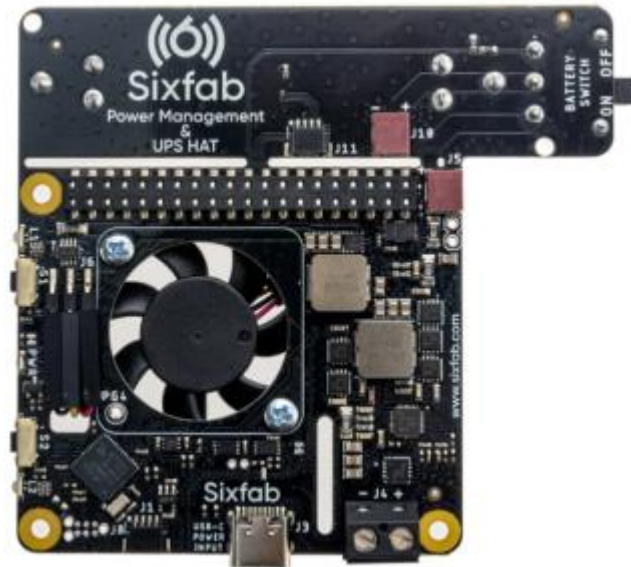
Рисунок 2.4 - UPS HAT, підключений до Raspberry Pi.
