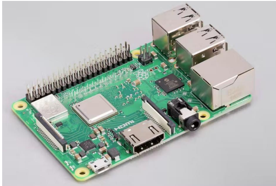
Рисунок 2.3 - Зображення Raspberry Pi 3B+.
