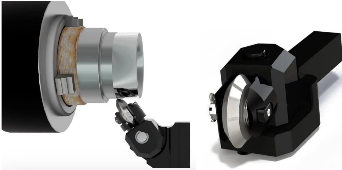
Рисунок 1.8 – Інструмент для вигладжування циліндричних поверхонь компанії Cogsdill [30]
