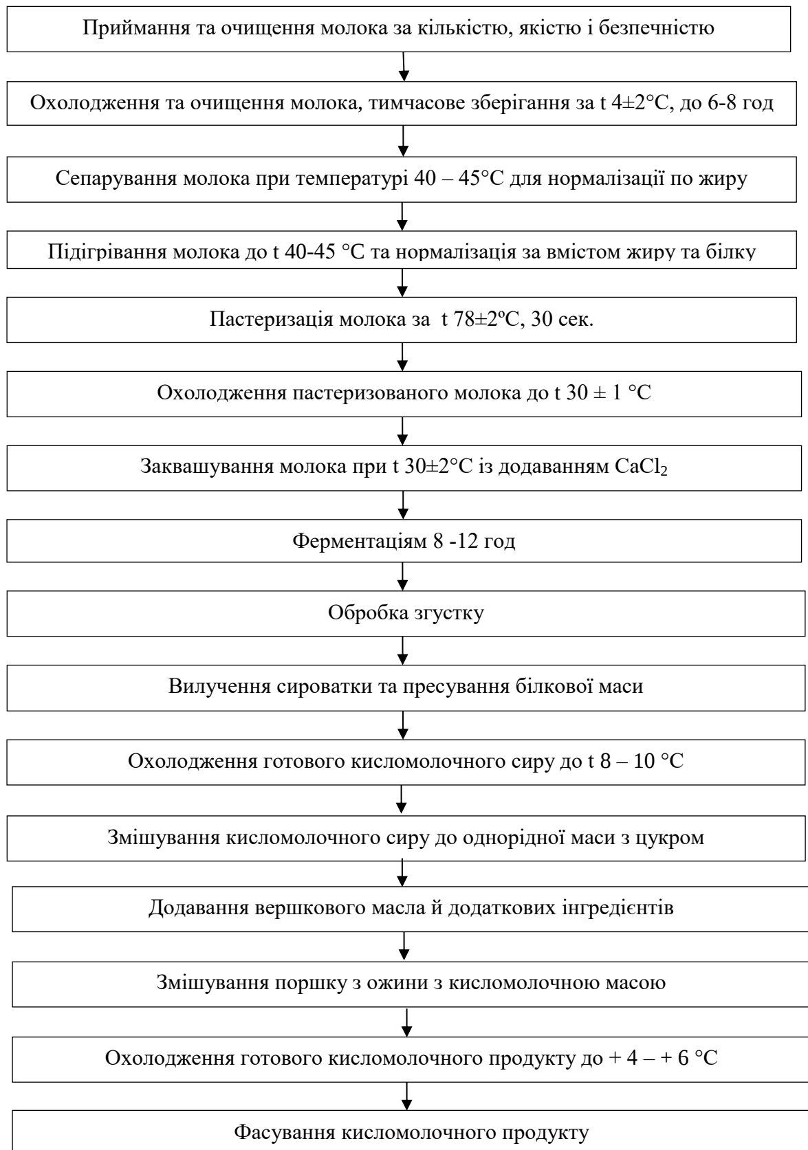
Рис. 1.1. Схема технологічного процесу виробництва солодкого кисломолочного виробу з ожиною
