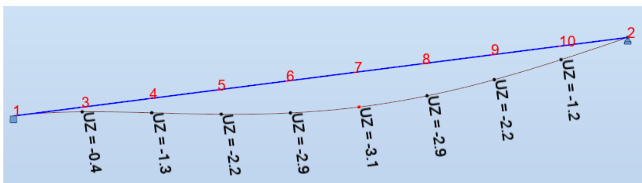
Рисунок 3.7 - Розрахункова деформація балки для двотавра 40Б1
