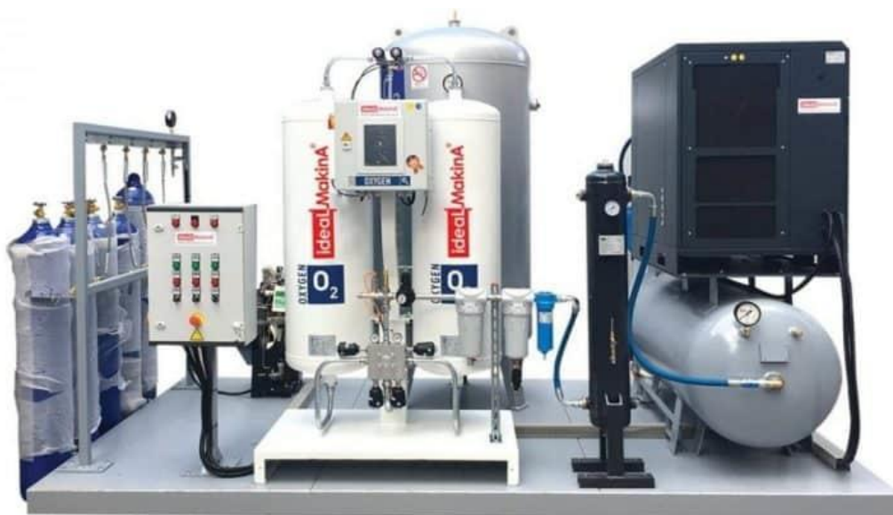
Рисунок 3.13 - Обладнання запропонованої до впровадження кисневої станції
