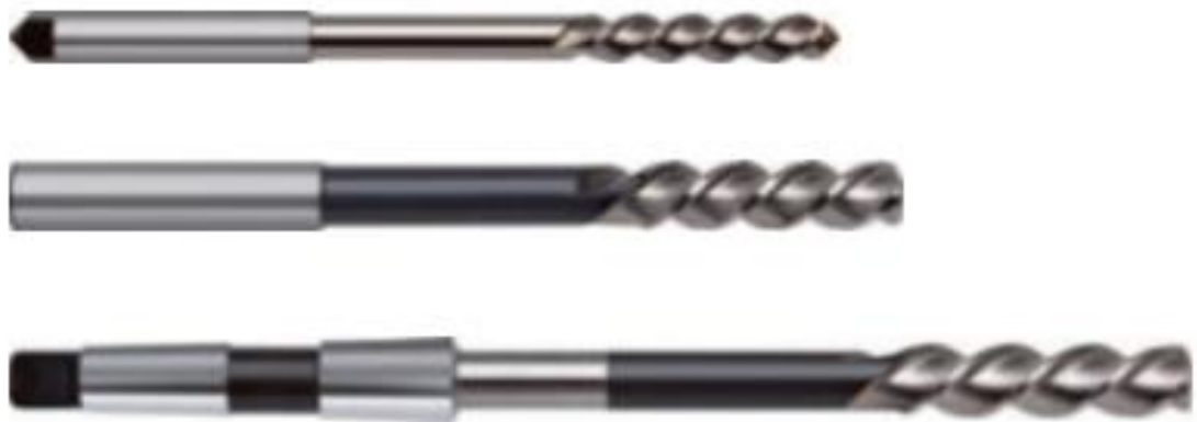
Рисунок 1.11 – Гвинтові розвертка H7 Guehring з кутом спіралі 45°
