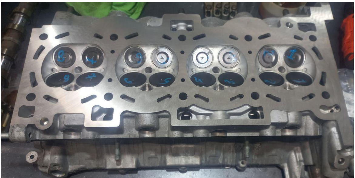
Рисунок 1.3 – Відремонтована ГБЦ KIA Optima 2,4 л G4KE [26]
