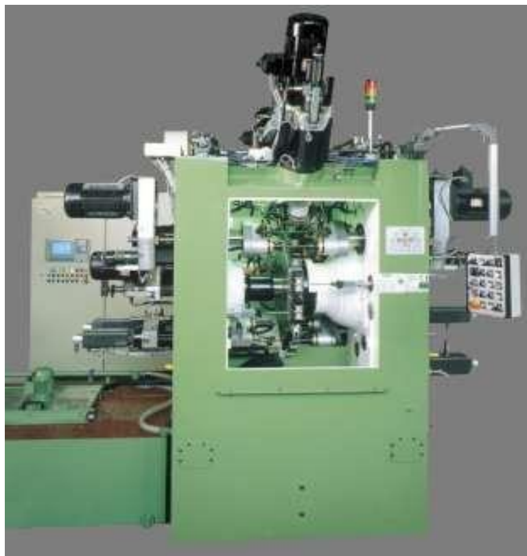
Рисунок 1.7 – Компонівка агрегатного верстата з поворотно-ділильним барабаном Picchi TR 6-9/OSE
