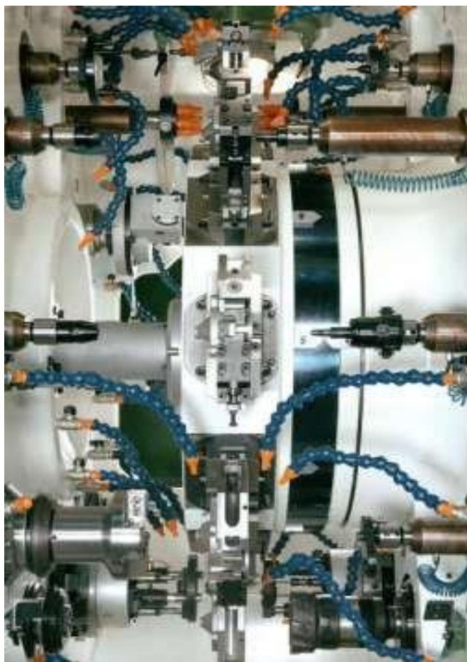
Рисунок 1.9 – Загальний вид поворотно-ділильного барабана фірми Porta Solutions
