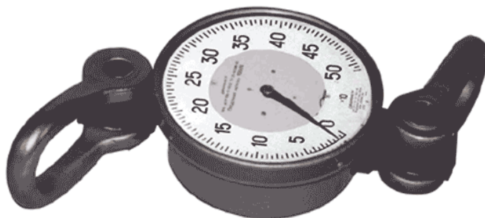
Рисунок 1.10 Динамометр розтягу ДПУ–500–2 500кН/50т
