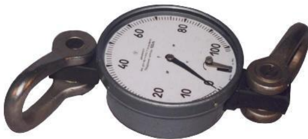
Рисунок 1.9 Динамометр розтягу ДПУ–100–1 100кН/10т
