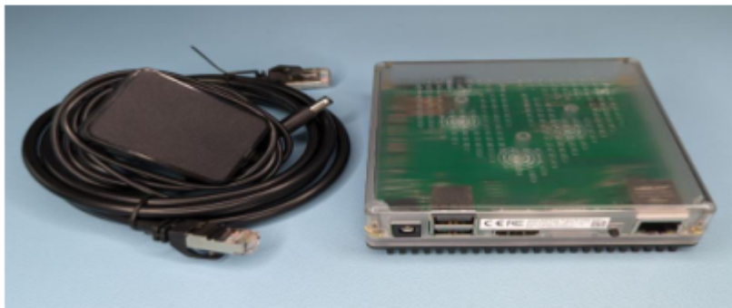
Рисунок 1. Raspberry PI, на базі якого реалізовано Home Assistant
