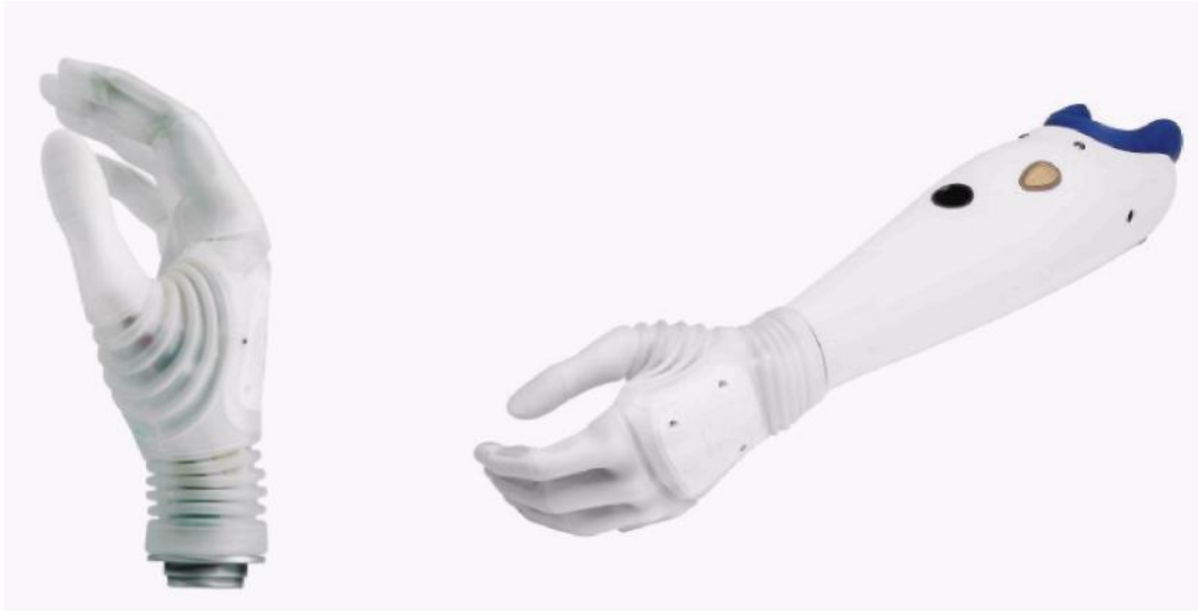
Рис. 1.12. Кисть Michelangelo та протез передпліччя на її основі
