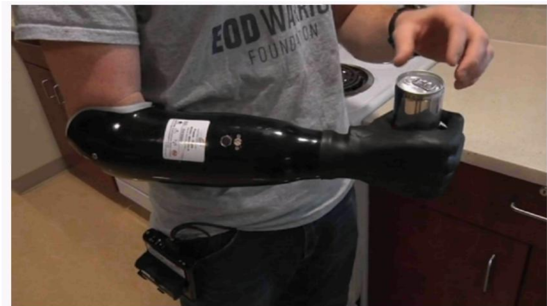
Рис. 1.9. Протез на основі IMES
