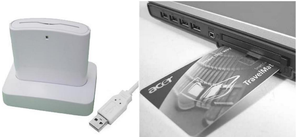
Рисунок 3.3 – Контактні пристрої зчитування для інтелектуальних карт, що підключаються через USB-порт (зліва) або вставляються у відповідний слот ноутбука (праворуч) [31]
