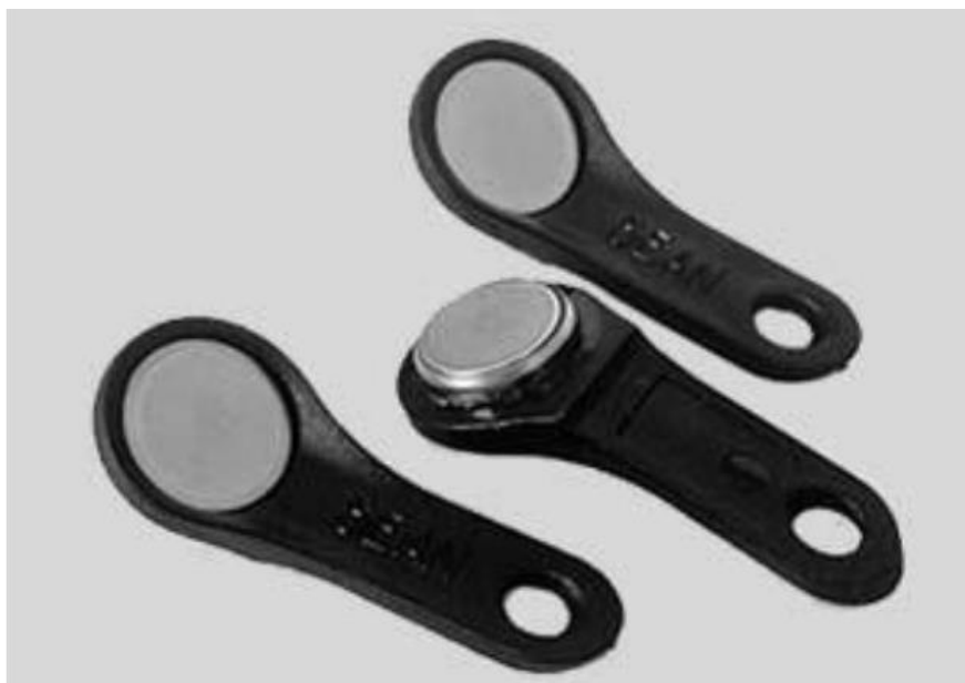
Рисунок 3.4 – iButton – сімейство мікроелектронних пристроїв, розроблених фірмою Dallas Semiconductor (USA) [31]
