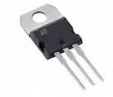
Рисунок 2.7 – Зовнішній вигляд мікросхеми типу KP142EH8V TO220
