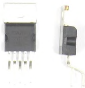
Рисунок 2.4 – Зовнішній вигляд мікросхеми TDA2003
