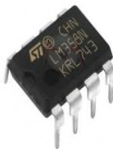
Рисунок 2.6 Зовнішній вигляд мікросхеми LM358N
