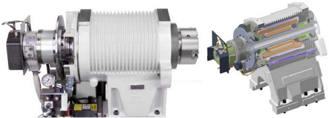
Рис. 1.6 - Привід головного руху у вигляді мотор-шпинделя
