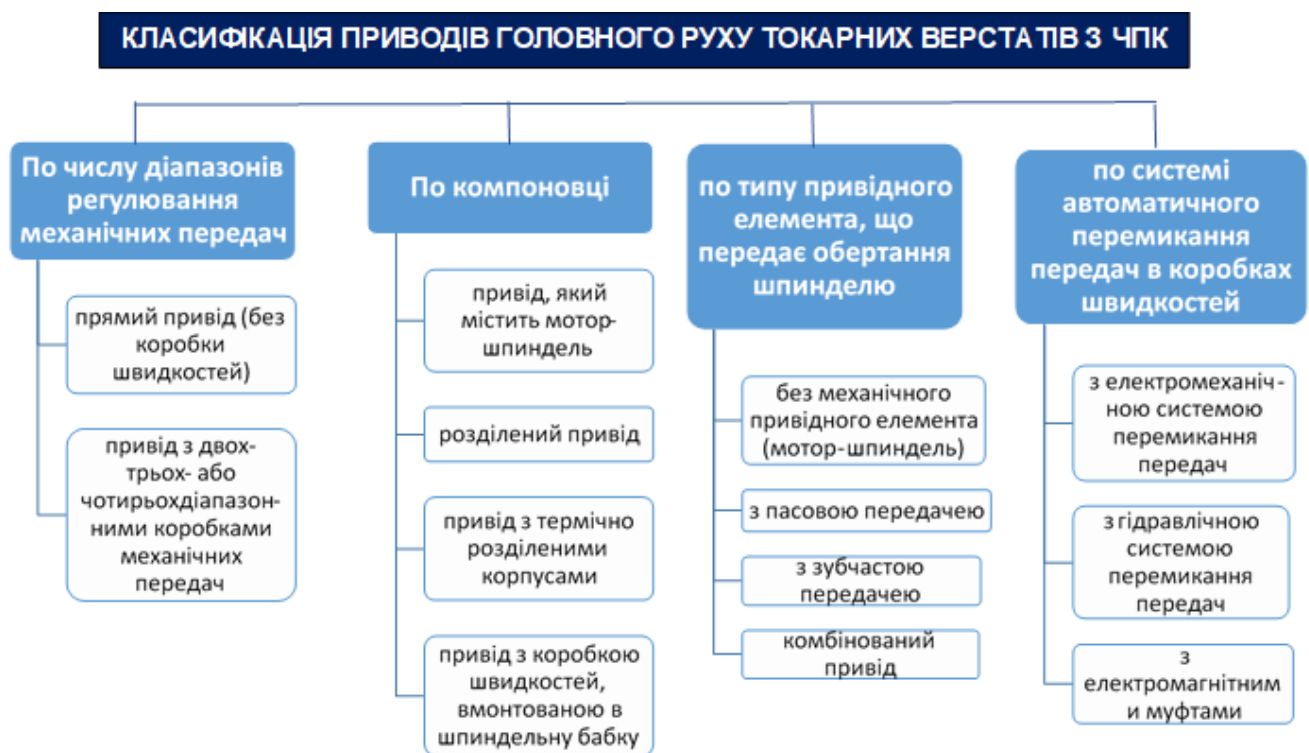
Рис.1.2 - Класифікація приводів головного руху токарних верстатів з ЧПК
