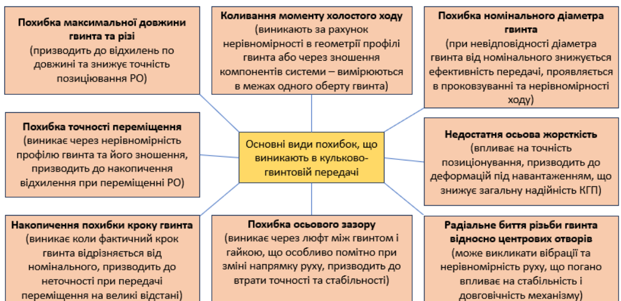
Рис. 3.7. Основні похибки, що виникають в роботі КГП
