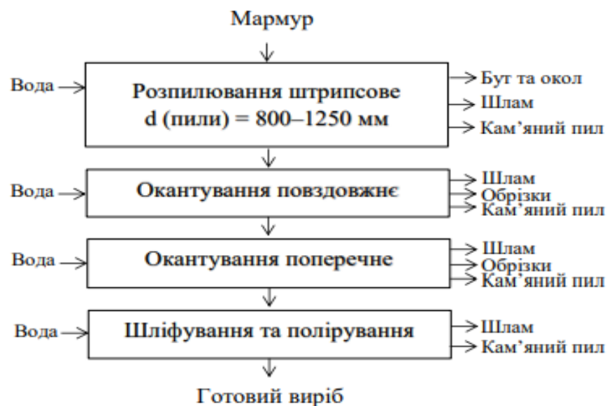
Рис. 2.3. Технологічна схема обробки виробів з мармуру
