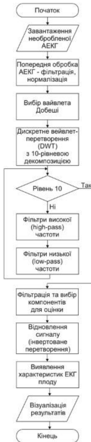
Рис. 3.2 Блок схема аналізу фетальної електрокардіограми
