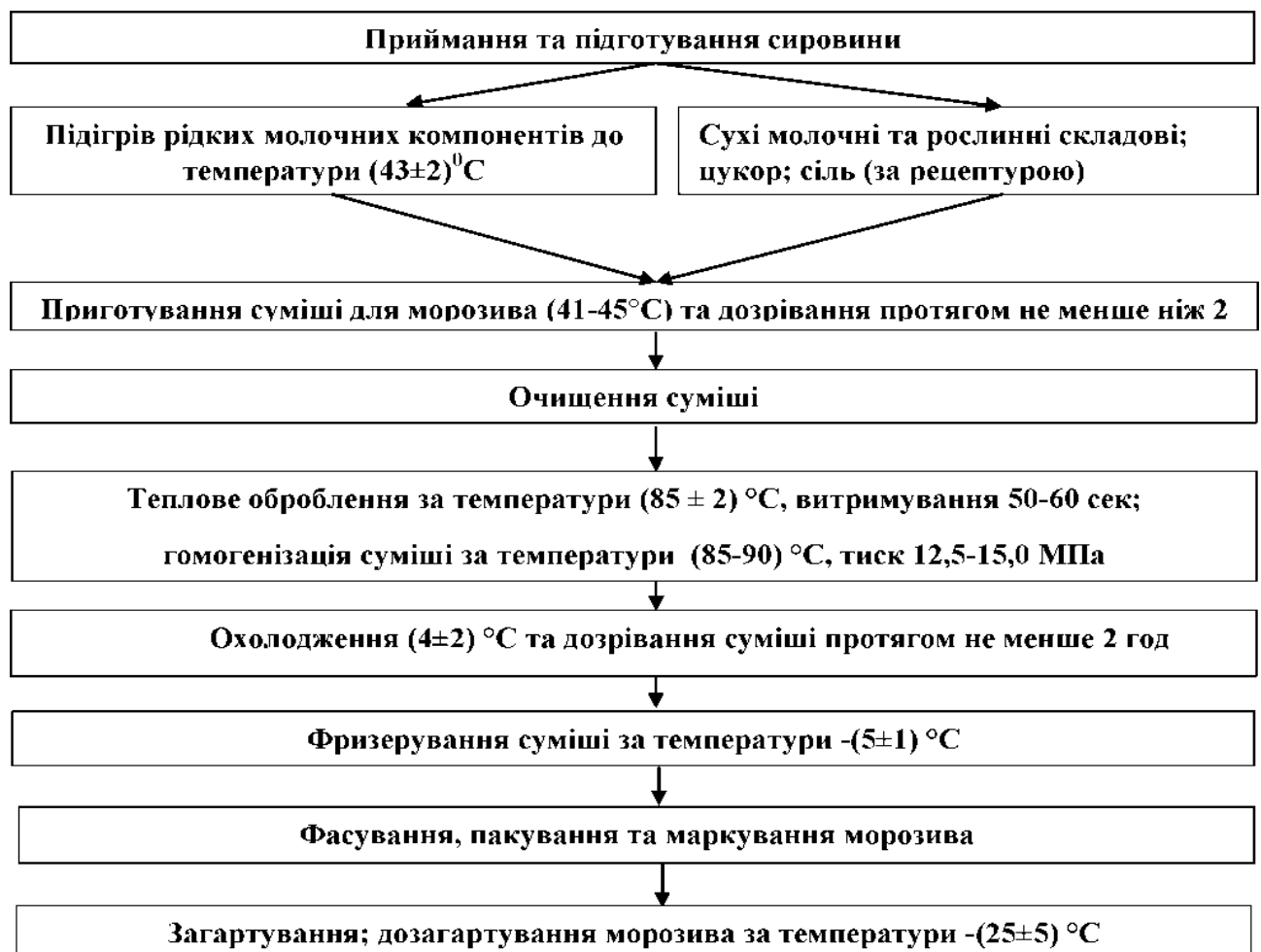
Рисунок 3.2 - Технологічна схема, за якою пропонується здійснювати виробництво низькокалорійного молочного морозива на ТОВ «Галичина Ласунка» [19]
