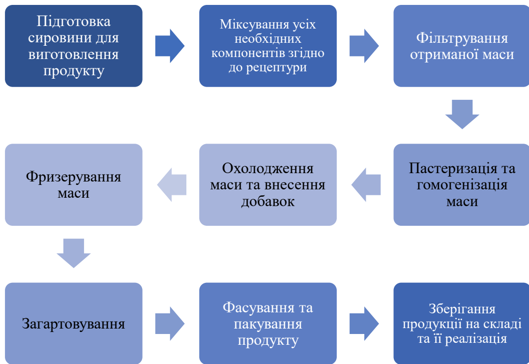
Рисунок 3.1 – Схематичний опис технології виробництва морозива із внесенням натуральних добавок різних видів плодово-овочевої сировини
