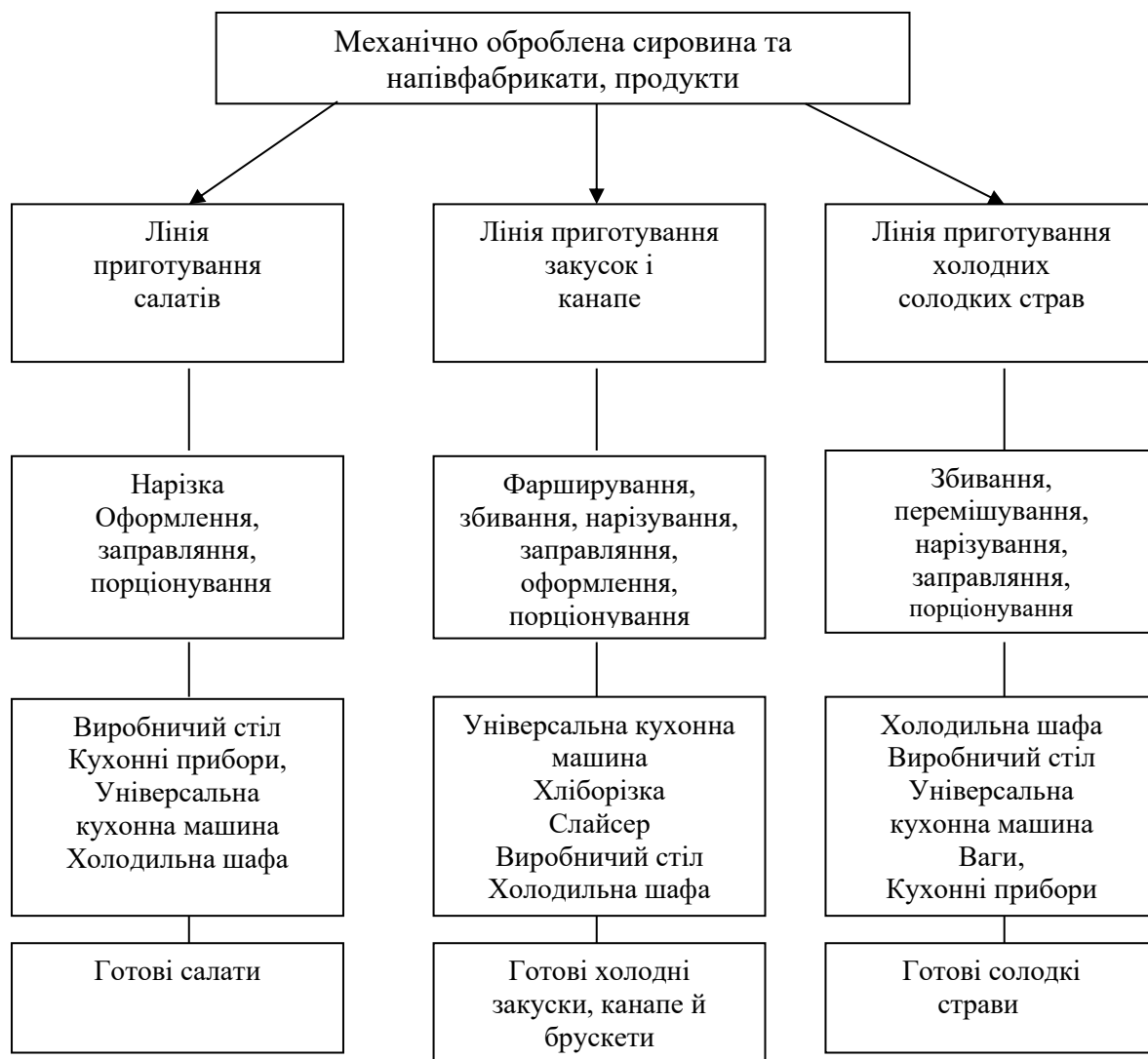
Рис. 2.5. Схема виробничого процесу холодного цеху ресторану «Mirax»
