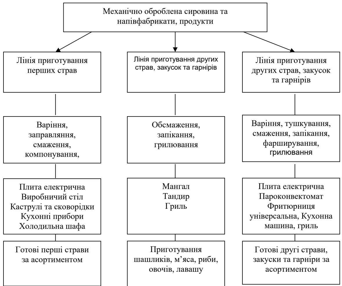
Рис. 2.4. Схема виробничого процесу гарячого цеху ресторану «Mirax»
