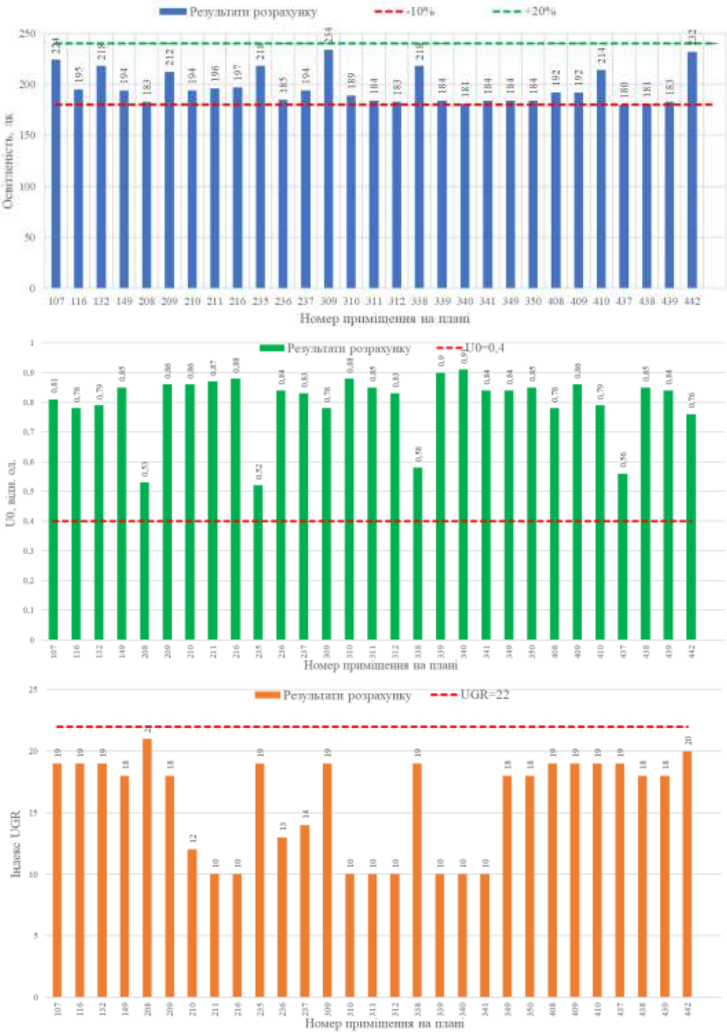
Рисунок 3.10 – Діаграми значень освітленості (а), коефіцієнта рівномірності її розподілу (б) та індексу UGR (в) для приміщень санвузлів
