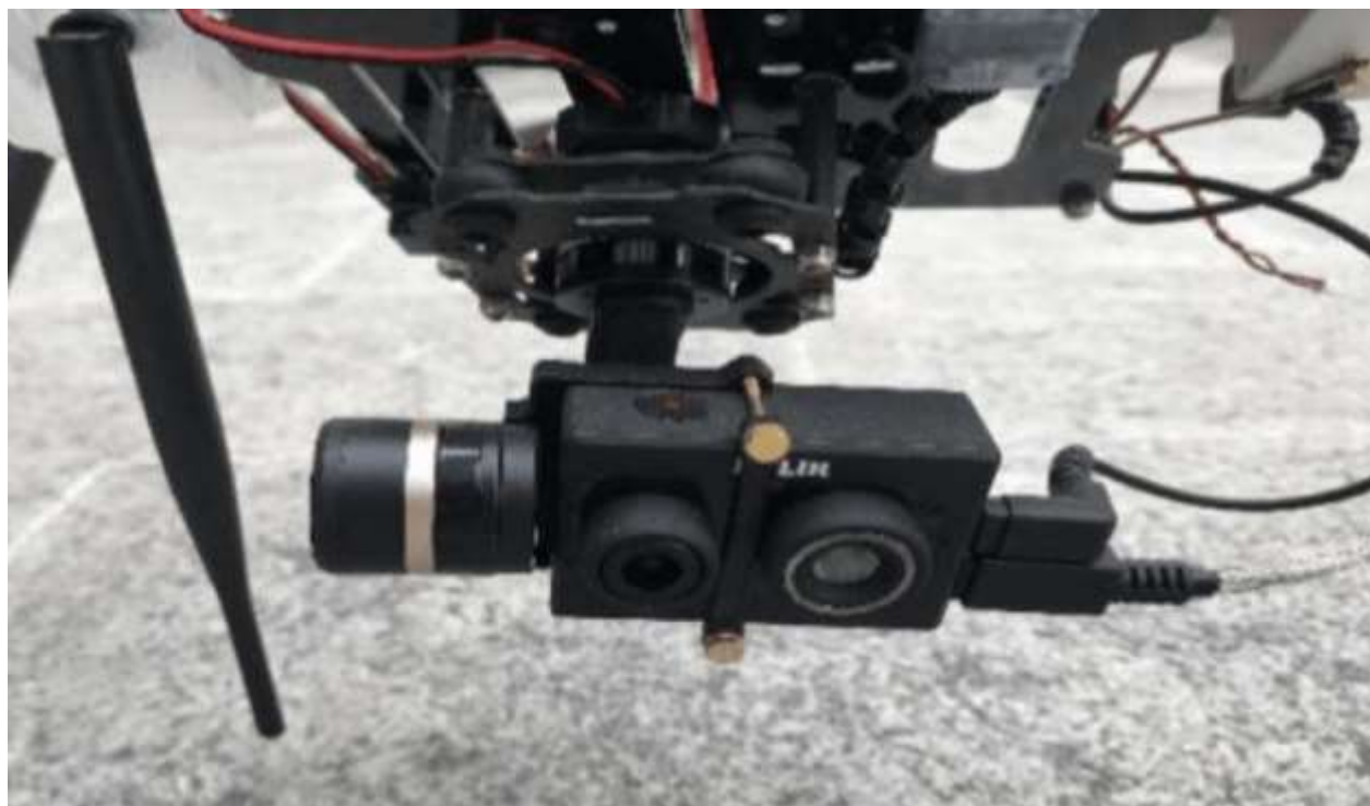
Рисунок 2.1 – Загальний вигляд БПЛА з камерами теплового та видимого світла: ( а ) БПЛА, ( б ) Теплова камера FLIR
