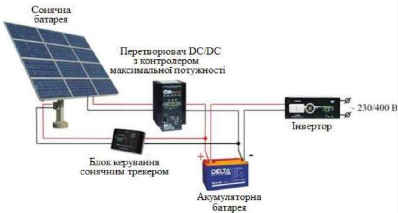
Рисунок 3.1 – Схематичне зображення сонячної електростанції
