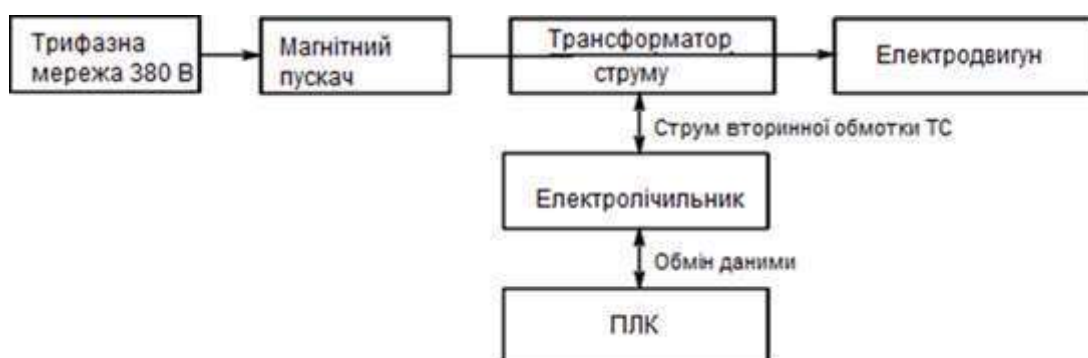
Рисунок 2.18 – Структурна схема підключення лічильників електроенергії
