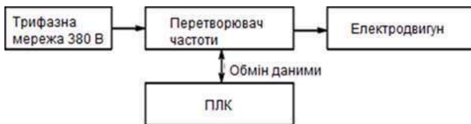
Рисунок 2.17 – Структурна схема включення ПЧ до електродвигуна
