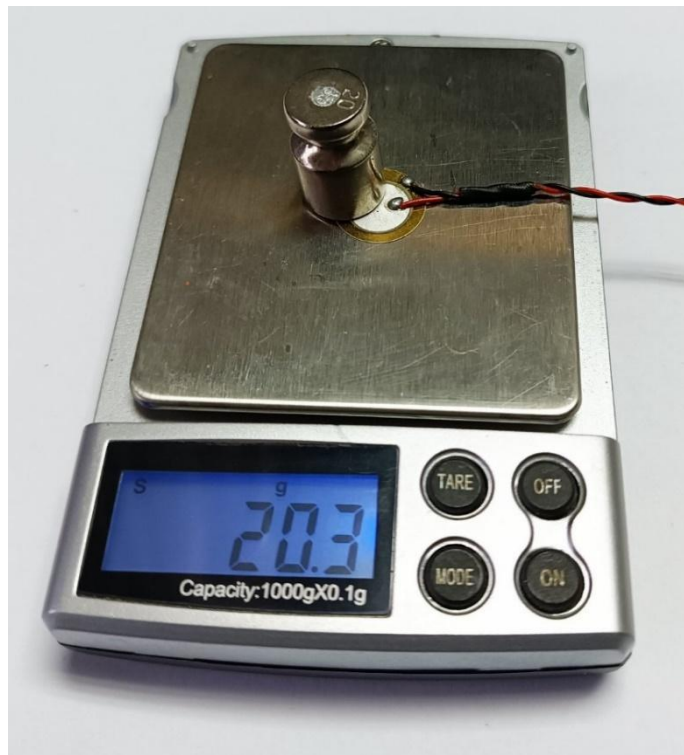
Рис.3.7. Встановлення контрольної ваги 20 гр, для імітації натиску пальця
