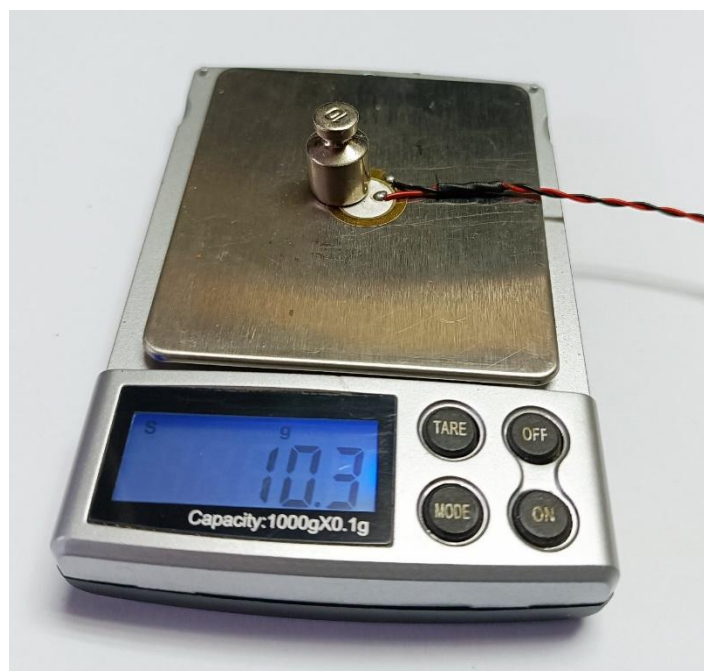
Рис.3.5 Встановлення контрольної ваги 10 гр, для імітації натиску
