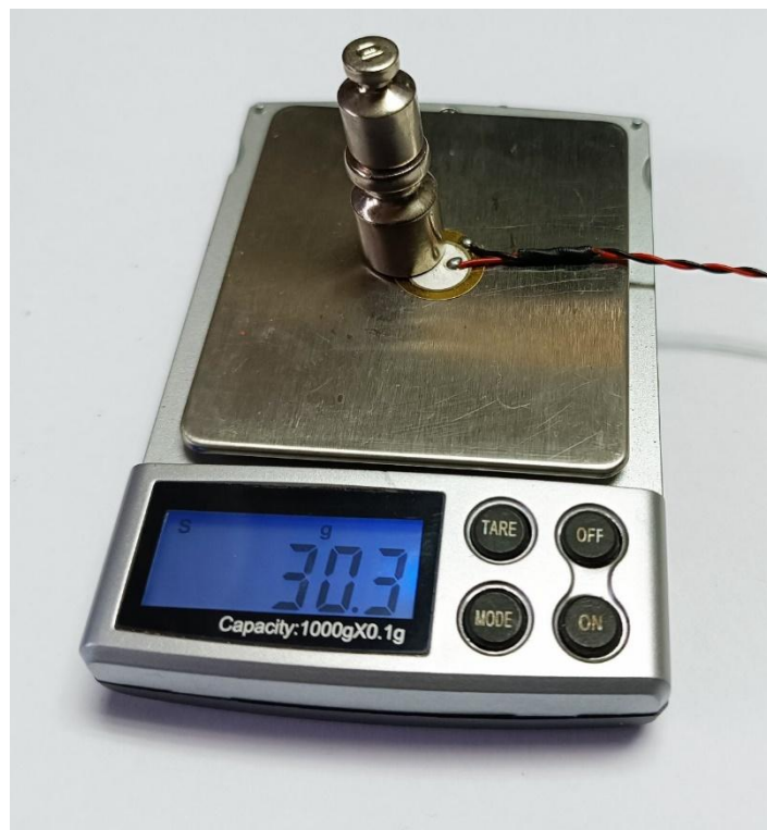
Рис.3.9. Встановлення контрольної ваги 30 гр, для імітації натиску пальця
