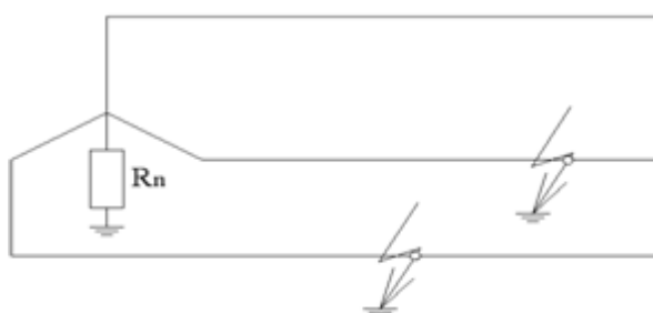
Рисунок 2.9 – Режим подвійного короткого замикання на землю
