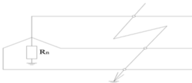
Рисунок 2.4 - Режим трифазного короткого замикання на землю
