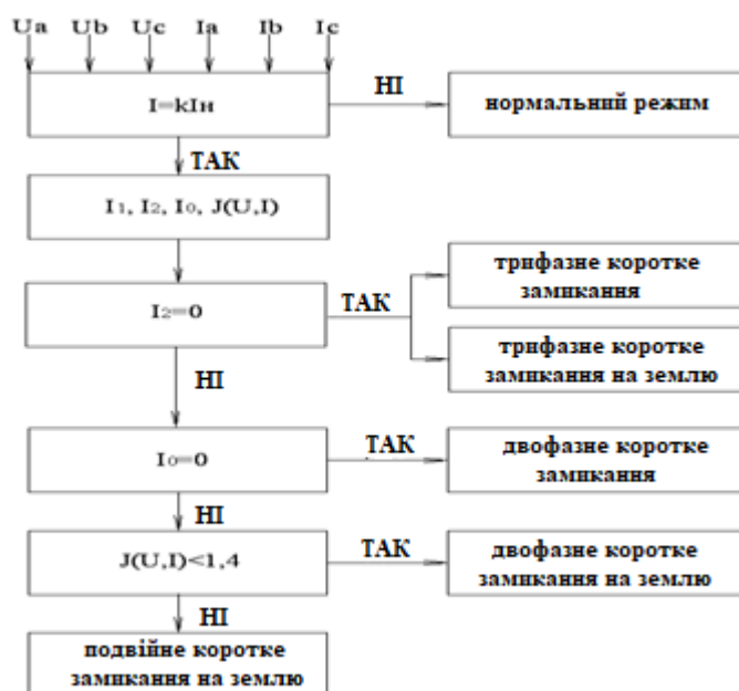
Рисунок 3.9 – Алгоритм визначення виду міжфазних пошкоджень досліджуваної мережі
