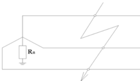
Рисунок 2.2 – Режим трифазного короткого замикання
