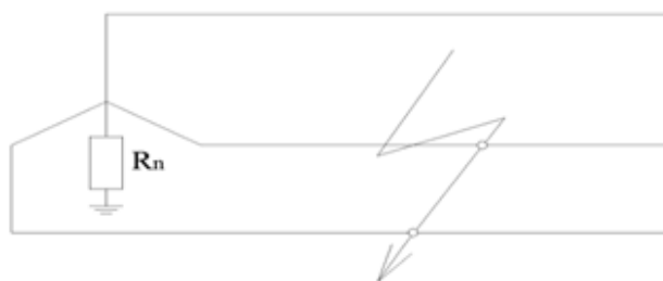
Рисунок 2.5 – Режим двофазного короткого замикання
