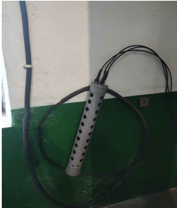
Рисунок 3.11 - Зовнішній вигляд баласту катодного типу 30 кВт
