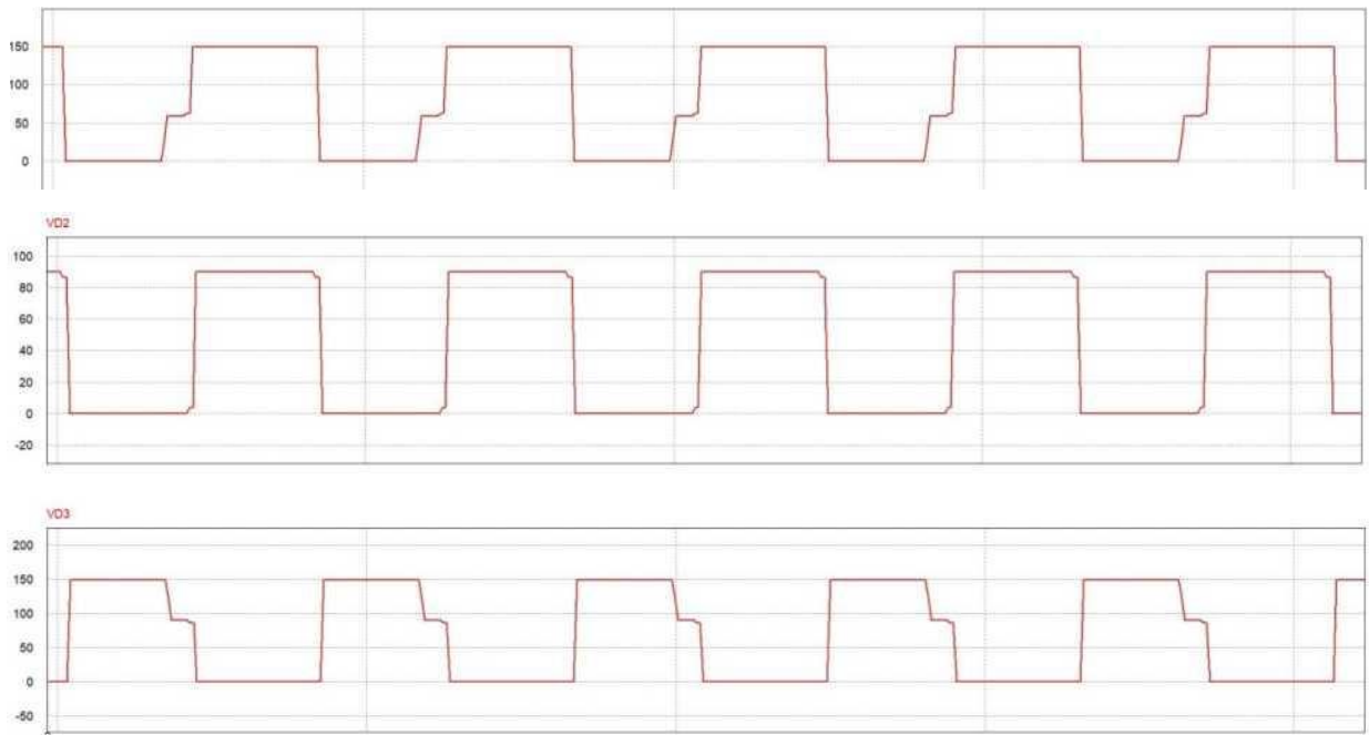
Рисунок 2.19 – Осцилограми напруги діодів D1, D2 і D3.
