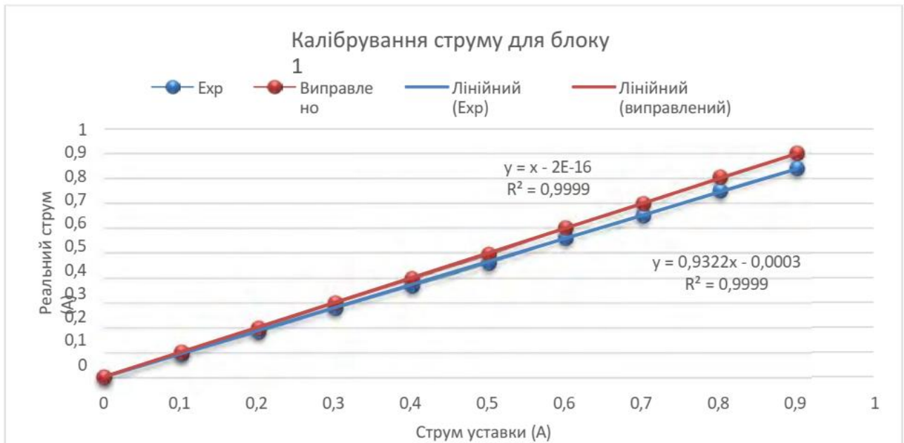
Рисунок 3.14 – Графік калібрування струму для боксу 1
