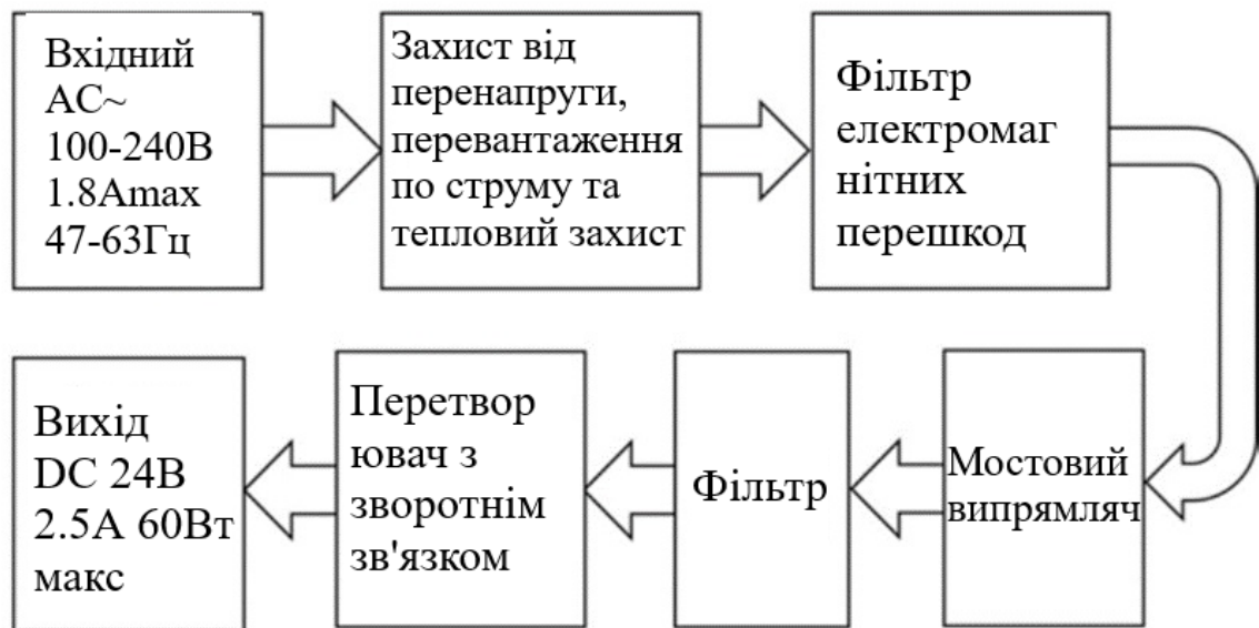
Рисунок 3.4 - Блок-схема структури системи живлення світлодіодного освітлення
